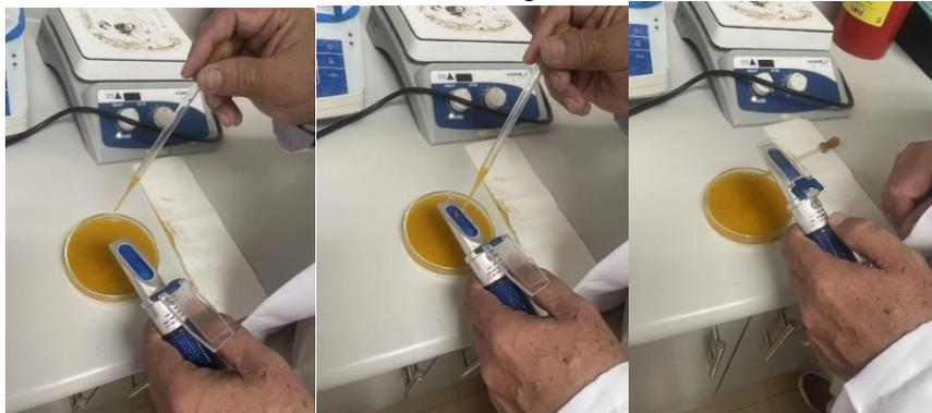
Para medir grados Brix del producto se tomó una pequeña cantidad de producto ya preparado con una pipeta y con el asa, posterior a esto, se agregó unas gotas de agua, se cierra, se asegura el refractómetro y observamos el resultado que refleja.
