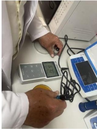
Para medir el pH del producto, se tomó una cantidad del ADOBO en otro recipiente, se agregó un poco de agua, se introduce el medidor del pHmetro y se refleja el resultado de pH en la pantalla del equipo 5%.
