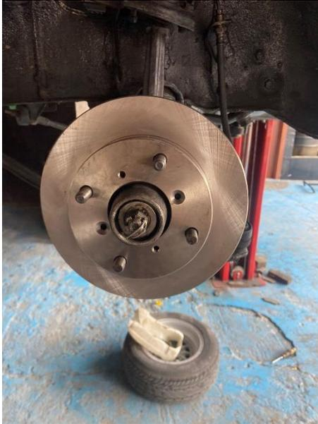
*Montaje de nuevo sistema de frenos (discos)*
