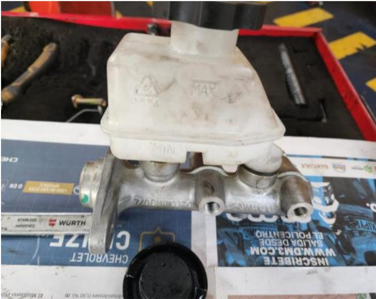
*Bomba del sistema de frenos de disco (7/8)*
