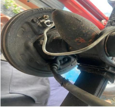
*Instalación y cambio de cañerías de la bomba de frenos*
