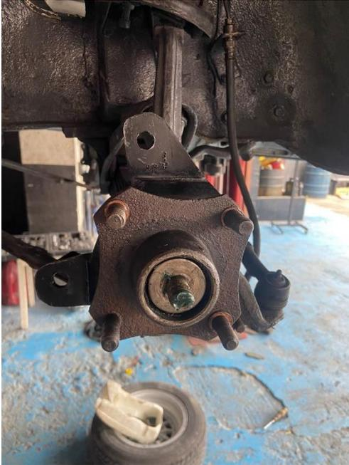
*Montaje de adaptación para nuevo sistema de frenos (Discos)*
