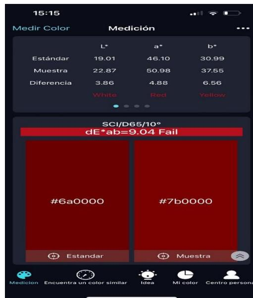
**Figura 7: datos arrojados por la aplicación del colorímetro**
