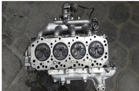
Figura AVI.1 Desmontaje del cabezote
