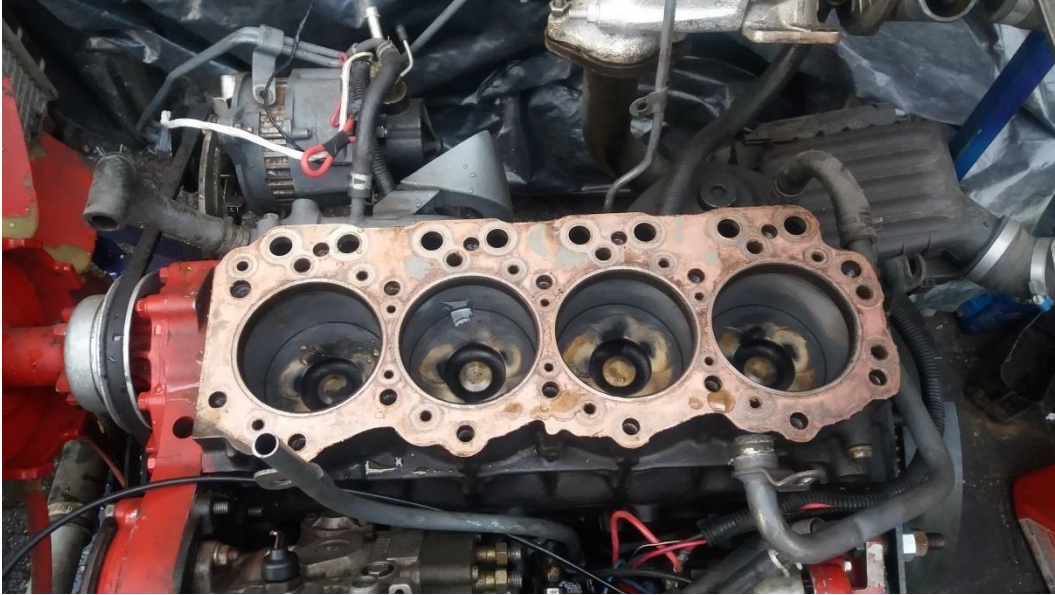
Figura AI.3 Desmontaje del cabezote
