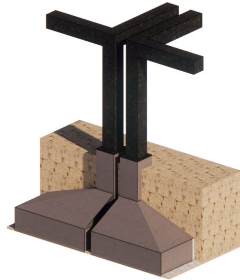
Imagen 108. Junta de construcción
