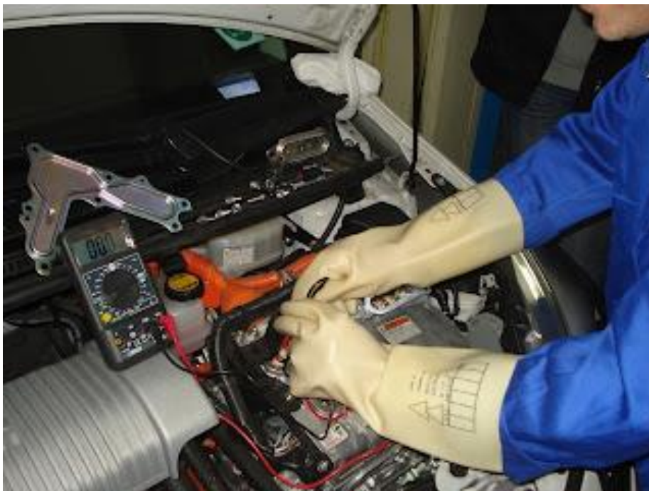
Precauciones en Circuitos de Alto Voltaje de un Vehículo Híbrido
