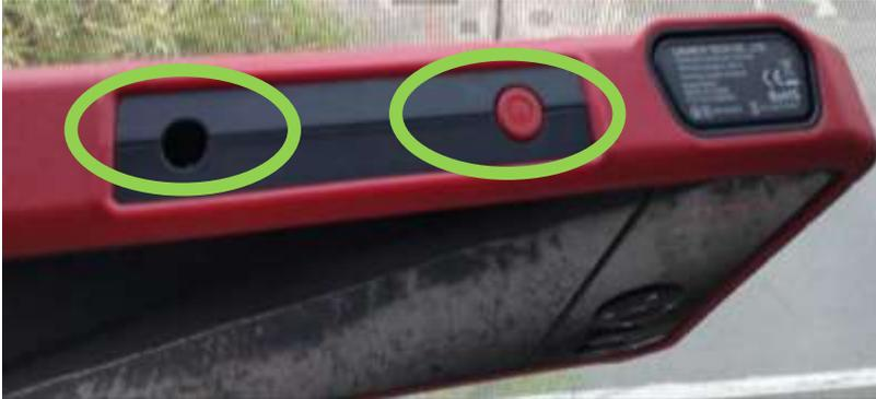
Paso 3: luego de encenderlo se procede a conectar el VCI, que es elemento de conexión y comunicación con el vehículo, ver figuras 30.
