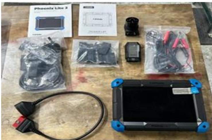
2. Se procede a encender el escáner, acción que se realiza con el botón de encendido que se encuentra en la parte superior izquierda; si no encendiera por falta de carga se debe conectar a una fuente de alimentación eléctrica, el punto de entrada de corriente se encuentra en la parte superior derecha; el cable de alimentación de corriente es de tipo c y viene incluido en el set de elementos de escáner, lo descrito se resalta en la figura 25.
