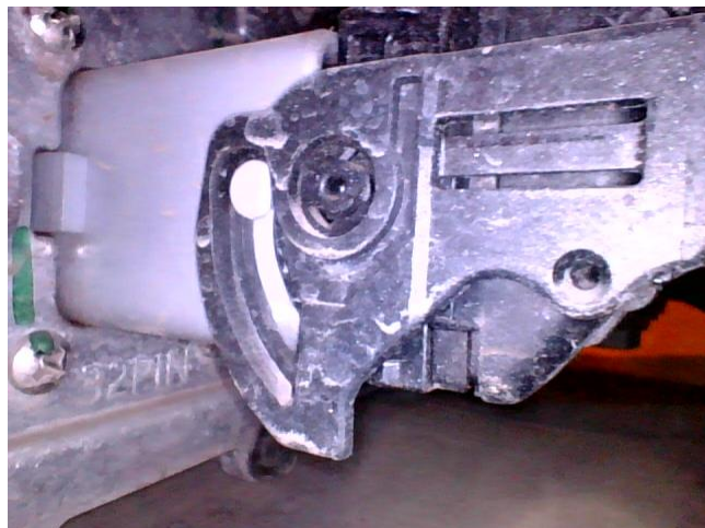
Conector de Parte Lógica de la Batería MG SZ EV
