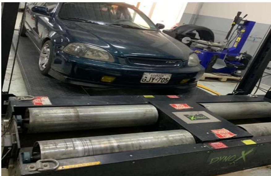
Una vez montado el vehículo en el banco de pruebas se procede a encenderlo y poner en marcha para luego acelerarlo de esta manera se consigue verificar el estado inicial del motor.
