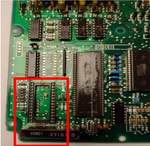
*Paso 5:* una vez soldado el porta chip se procede a ubicar el chip Cobra RTP y se lo asegura con un tornillo que viene en el mismo chip. Esto se visualiza en la figura 26, el circulo de contorno amarillo.
