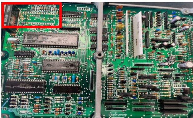
*Paso 2:* se localiza la ranura donde va a ser instalado el chip Cobra RTP. Como se muestra a continuación en la figura 23.
