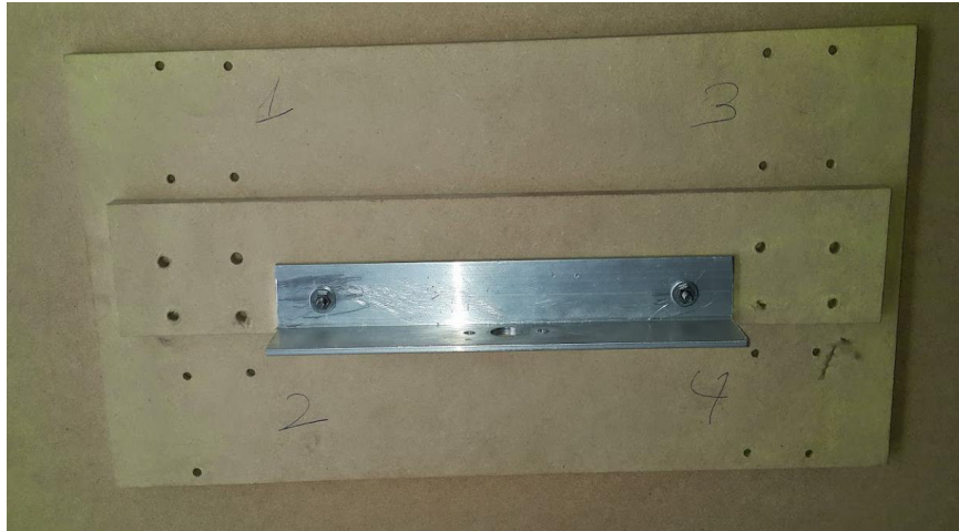
Figura 4.8 Fotografía de la mesa X acoplada al ángulo de aluminio.
