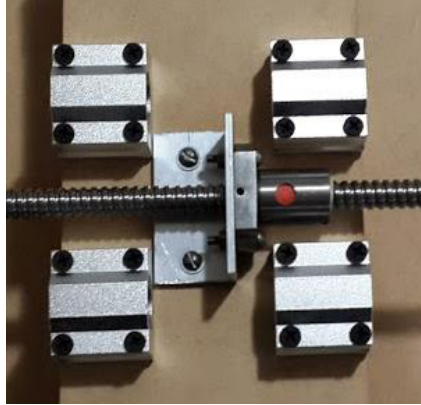
Figura 4.25 Fotografía de los rodamientos lineales SC12UU de 12mm acoplados al espaldar Z
