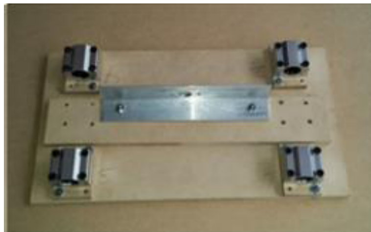
Figura 4.9 Fotografía de los rodamientos lineales de 12mm SCS12UU acoplados a la mesa X.
