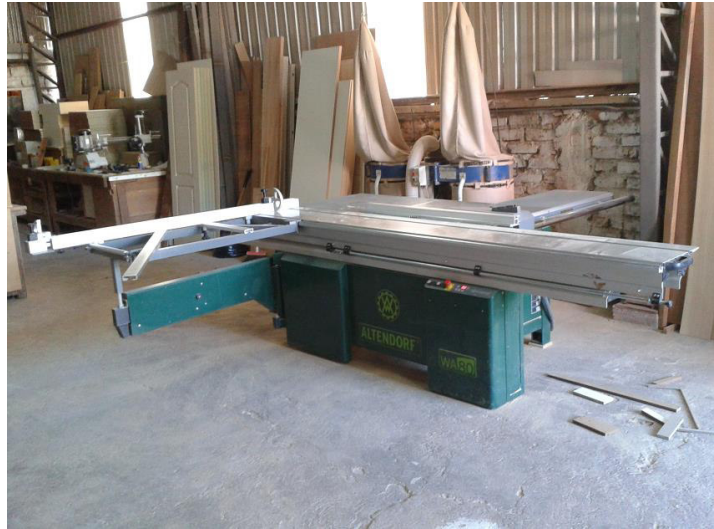
Figura 4.2 Fotografía de la sierra escuadradora.
