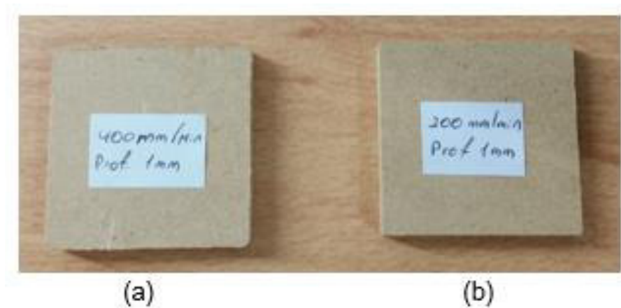
Figura 5.4 Fotografía de las pruebas de maquinado con 1mm de penetración en MDF. a) Maquinado a una velocidad de 400 mm/min. b) Maquinado a una velocidad de 200 mm/min
