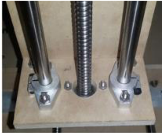
Figura 4.27 Fotografía del montaje de los ejes de 12mm, rodamientos 608ZZ y tornillo de bolas recirculantes
