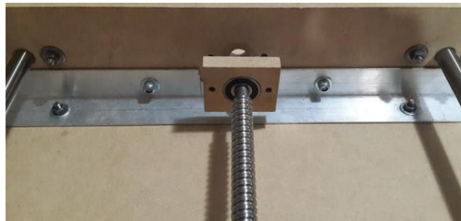
Figura 4.17 Fotografía del rodamiento axial acoplado al tornillo de bolas.
