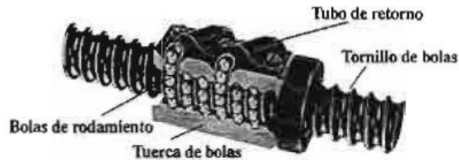
Figura 2.4 Tornillo de bolas recirculantes y tuerca
