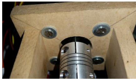
Figura 4.30 Fotografía del motor paso a paso anclada a la base
