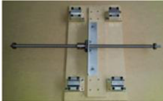
Figura 4.10 Fotografía de la tuerca y el tornillo de bolas acoplados al ángulo de aluminio.
