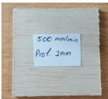
Figura 5.7 Fotografía de las pruebas de maquinado con 2mm de penetración en balsa
