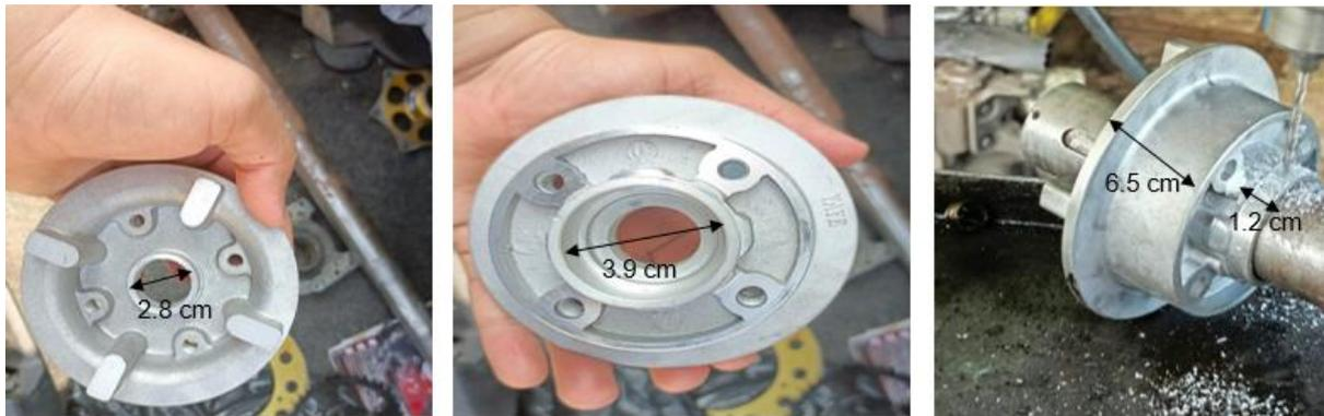
Como es un proceso de adaptación se procede hacer adecuaciones de la catalina a través de un torno logrando que el elemento pueda tener las dimensiones correspondientes para que se acople al eje principal como se puede ver en la figura 23.
