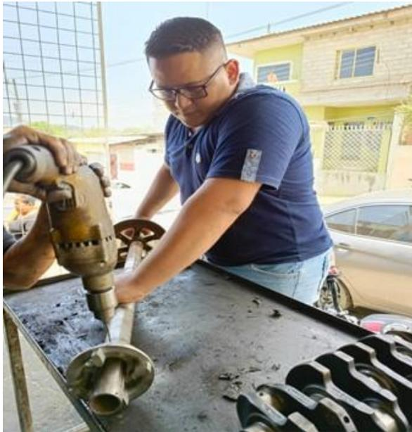
Luego se procede a modificar los largueros posteriores del chasis del kart y de esta manera se adapte el eje con su respectiva porta catalinas como se puede ver en la figura 25.
