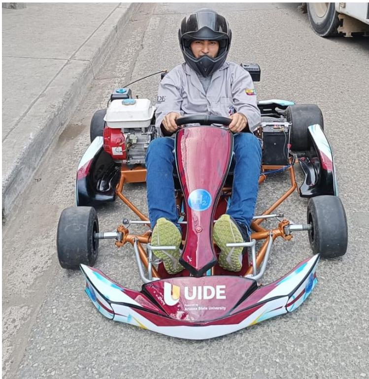
Ahora que con la implementación de todo el conjunto se realizó las pruebas de funcionamiento del kart con un sistema de generación de hidrógeno integrado son cruciales
