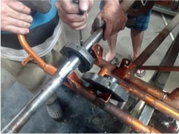
Con la ayuda de un calibrador Vernier, se procede a la toma de medidas con el fin de generar las adaptaciones pertinentes de los elementos que intervienen en el proceso, para lo cual las medidas a ser tomadas corresponden al eje de salida del cigüeñal o conocido como flecha de su diámetro, longitud y las dimensiones de la ranura de la porta chaveta, como se puede ver en la figura 20.
