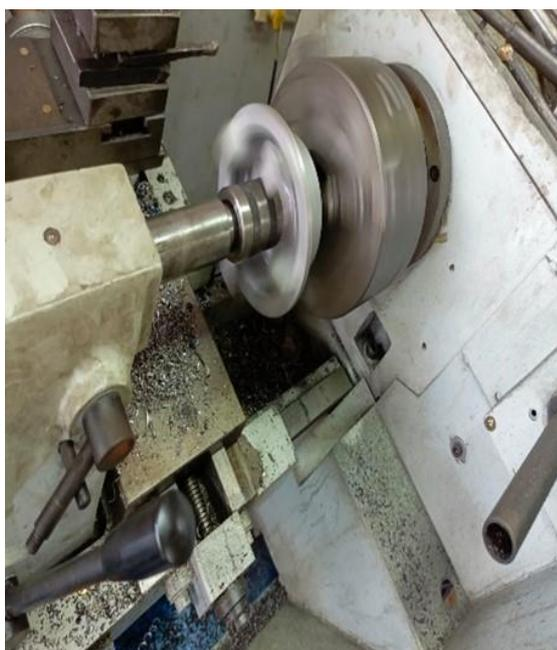
Una vez finalizada la acción del torno se procede a colocar en el eje principal del kart, posteriormente se realiza perforaciones con la ayuda de proceso de taladrado generando un orificio de  $\frac{1}{4}$  de pulgada y con machuelo la realización de rosca lo que permite la colocación de tornillería de sujeción entre eje, catalina y porta catalina. Esto se puede apreciar en la figura 24.
