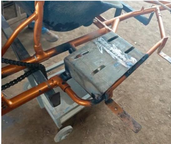
Luego con la ayuda de tornillería se procede a colocar el motor y se verifica su nivel u alineación entre piñón del motor, cadena y la catalina del eje, como se puede apreciar en la figura 28.
