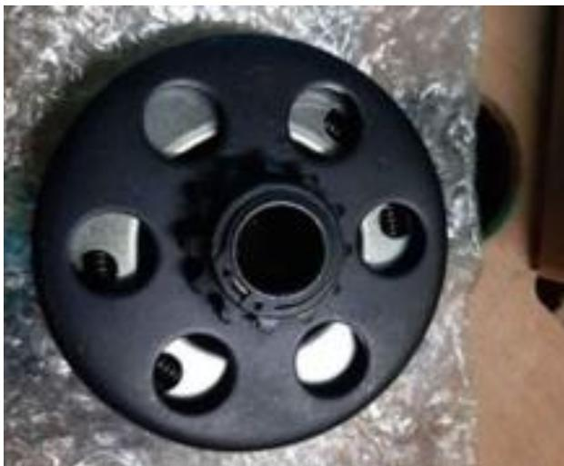
Una vez determinado el embrague centrífugo para el kart se procede a adquirir una porta catalina el mismo que irá colocada en el eje principal.
