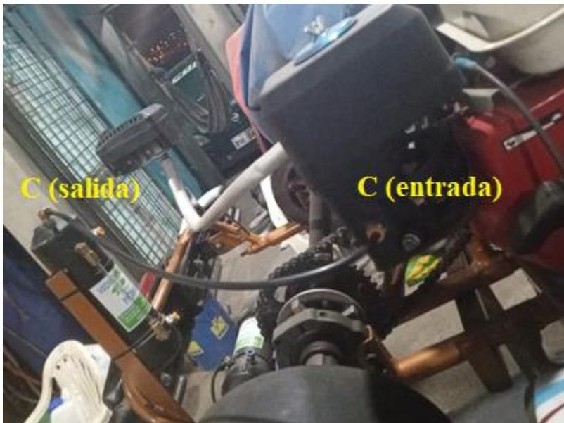
Para la alimentación de energía del borne positivo de la batería va conectado al interruptor en serie y luego a un fusible de 30 amperios, para luego conectarse al borne positivo del reactor, mientras que el borne negativo de la batería se conecta al borne negativo del reactor cerrando de esta manera el circuito eléctrico.
