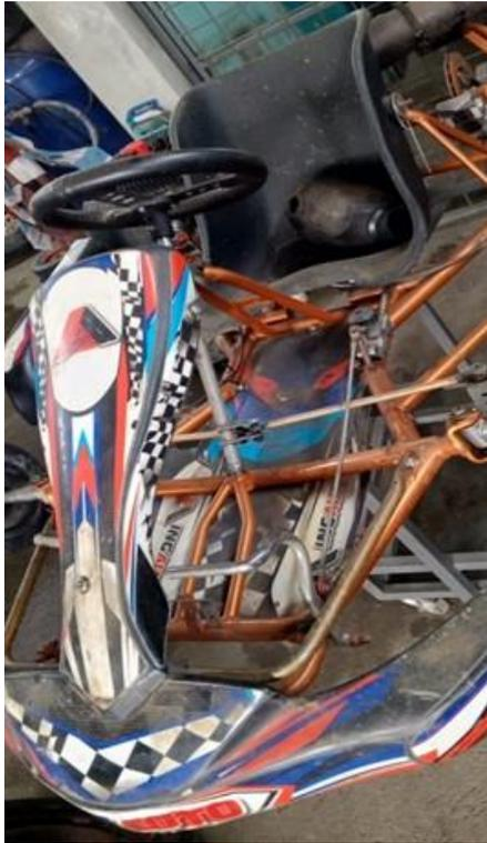
Para esta fase se procede a desmontar cada una de las molduras plásticas como lo es el alerón frontal, cuerpo frontal, molduras laterales y guardachoque posterior, eso se realiza por medio del desmontaje de vinchas de anclaje, así como de tornillería de sujeción, una vez finalizado esta etapa nos queda visible la parte del chasis del kart, como se puede ver en la figura 16.
