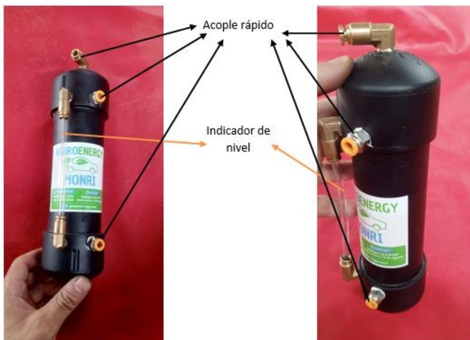
En cuanto a sus dimensiones externas se tiene un diámetro externo en su parte central de 2.4 in, el diámetro en los extremos es de 2.75 in y de longitud 7.5 in.
