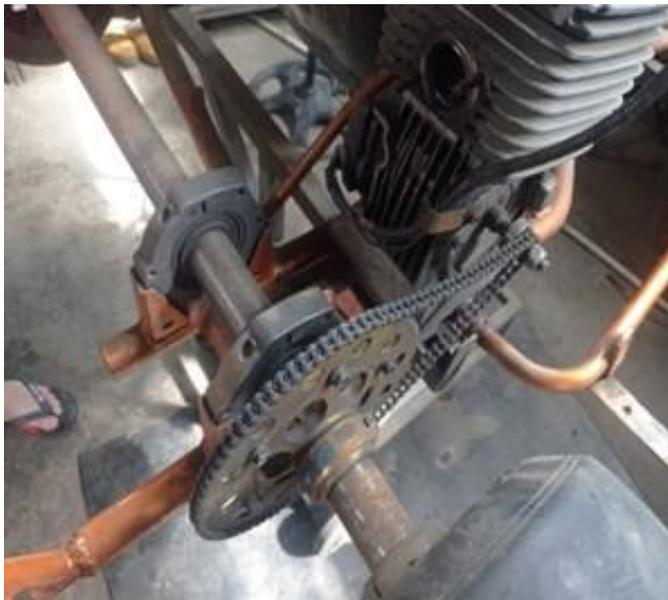
Luego se procede al desmontaje de los neumáticos tanto delanteros como posteriores para luego extraer el eje posterior por medio del desmontaje de las chumaceras que están conectadas al chasis del kart, como se puede observar en la figura 19.
