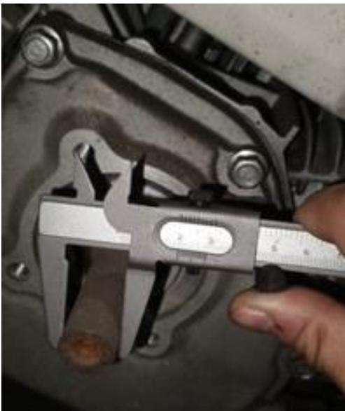
Con la información obtenida por la toma de medidas de la flecha del cigüeñal se procede a investigar qué tipo de embrague centrífugo se acopla a las características de la adaptación y el que se determina es un embrague que tienen las características que se pueden apreciar en la tabla 3.
