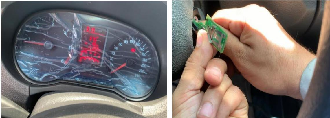
Se aprecia en el cuadro de instrumentos la marcha mínima que indica el encendido de la camioneta con el transponder (chip) programado, denotando en la misma que no existe un bloqueo o testigo que indique que la presencia del inmovilizador del vehículo este presente al probar el funcionamiento.
