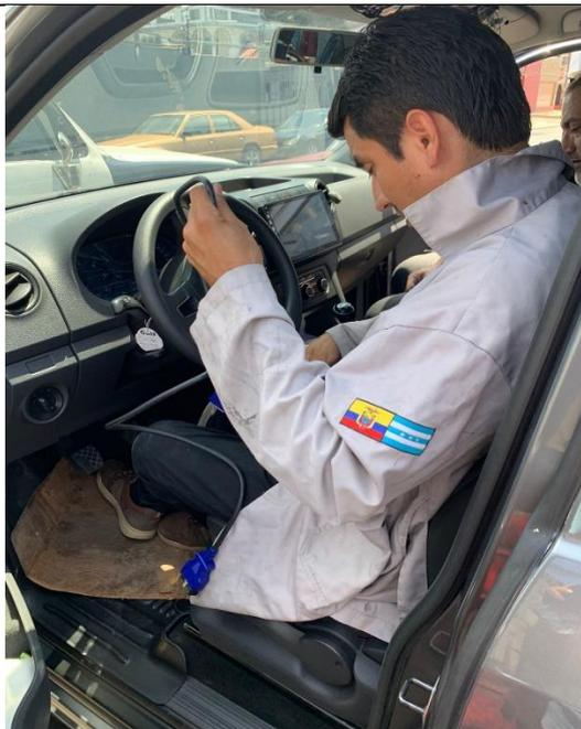
**Conexión del equipo IM508 con el vehículo a través del puerto OBDII**
