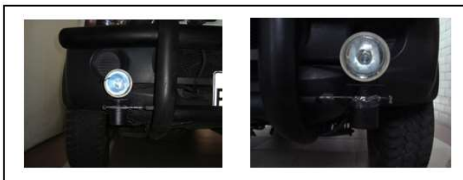
Figura 5.20 Neblineros montados en el vehículo
