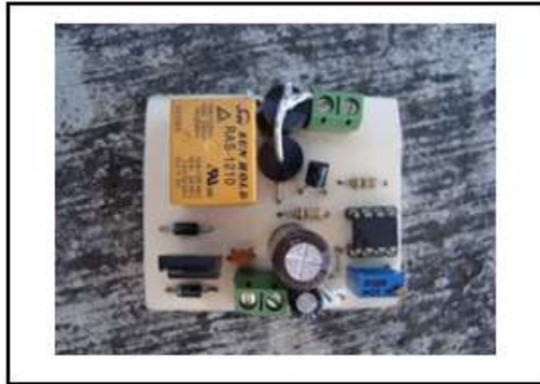
Figura 5.1 Placa de Encendido Automático de luces
