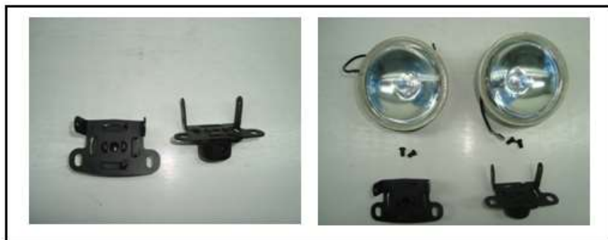
Figura 5.19 Base modificada y neblineras
