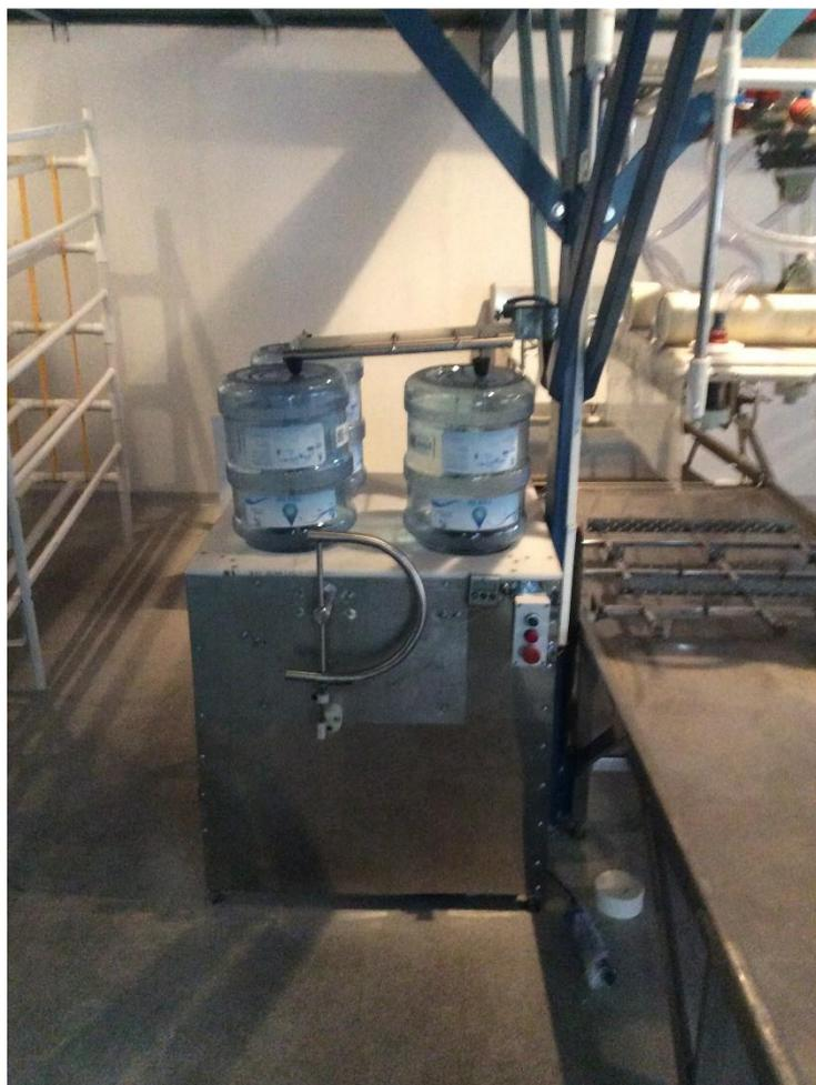
*Figura 4.13 Lavadora de botellones instalada en el área de trabajo.*
