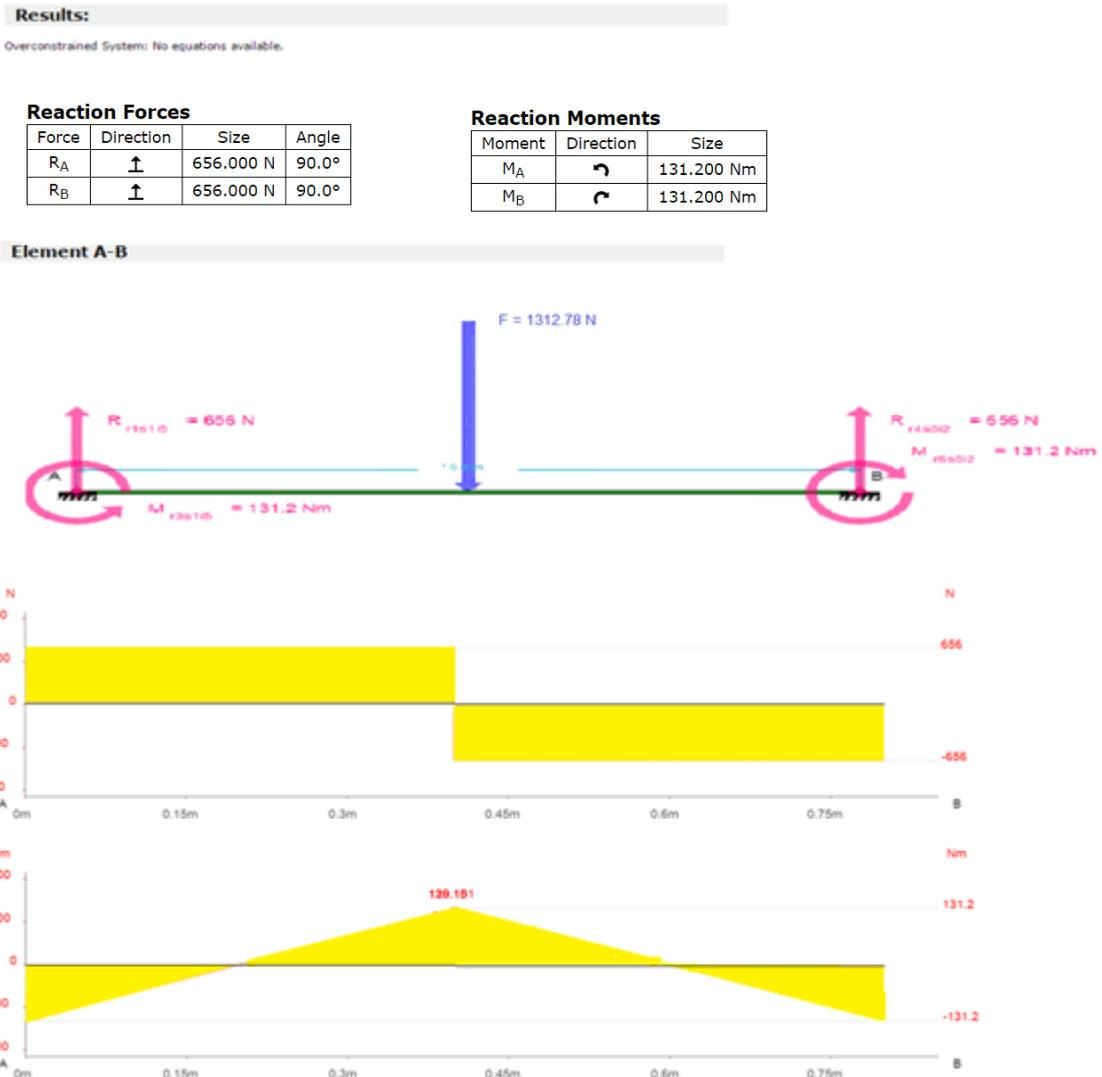
Figura 3.9 Diagrama de Cuerpo libre, Momento Cortante y Esfuerzo Flexionante
