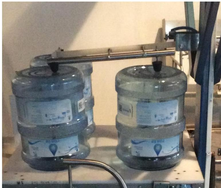
*Figura A.15 Brazo de Seguridad sobre los botellones*
