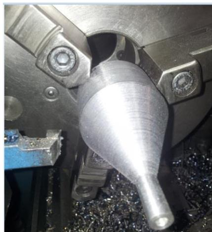
**Figura 4.4:** Boquilla de la extrusora
