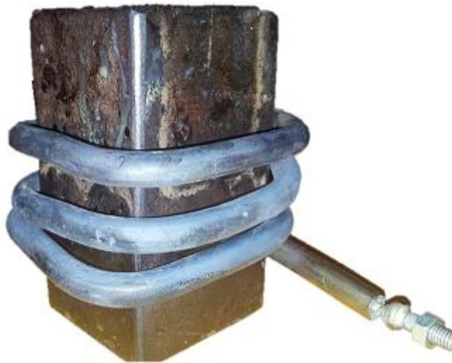
**Figura 4.14:** Ensamble Calefactor del Recibidor
