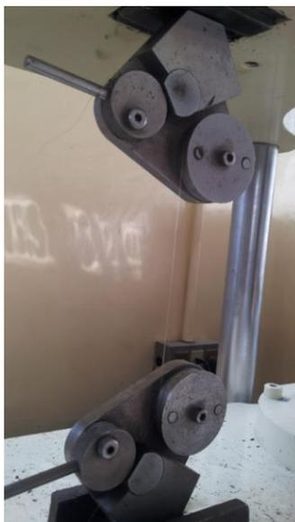
**Figura 4.27:** Prueba de elongación y tracción
