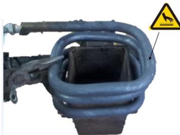
6. Retirar la boquilla en conjunto con el receptor para poder limpiar el material acumulado.
