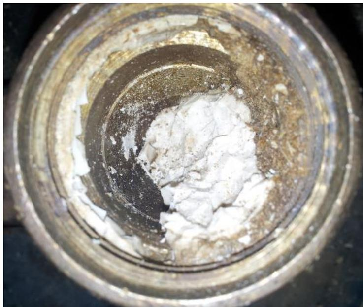
8. Se debe asegurar de igual forma que el tornillo extrusor quede sin material en su interior, por lo que se procederá a energizar de nuevo la máquina, el calefactor de la camisa y el variador de frecuencia. Para evitar que se produzca una subida en la corriente se debe calentar el calefactor a la misma temperatura de operación (300°C), posteriormente poner en marcha el motorreductor y dejar trabajar hasta que salga todo el material acumulado.
