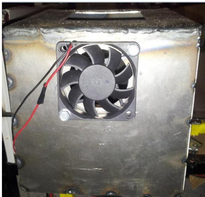
**Figura 4.16:** Ventiladores de enfriamiento del PET
