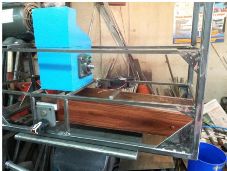
Figura 67. Montaje banda transportadora, ventilador y bomba de agua
