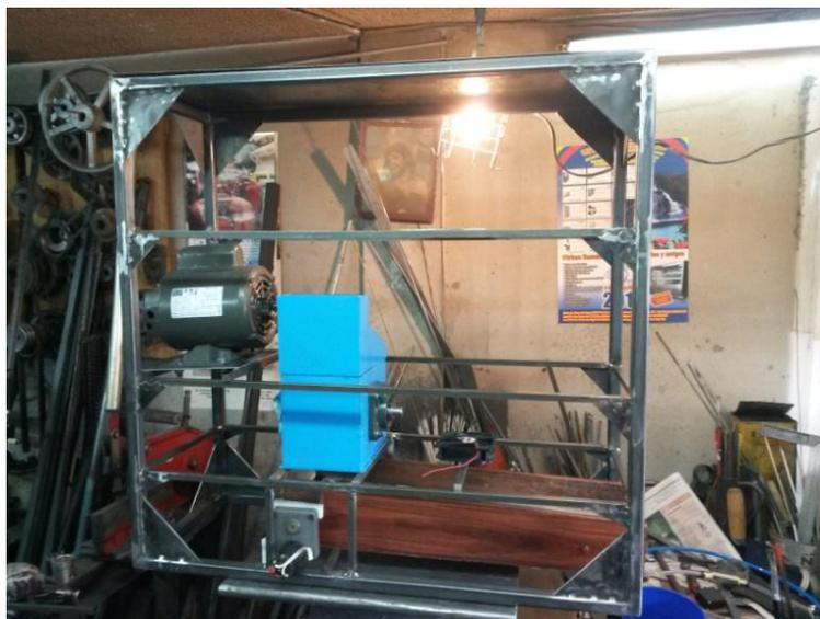
Figura 66. Adaptación del motor triturador
