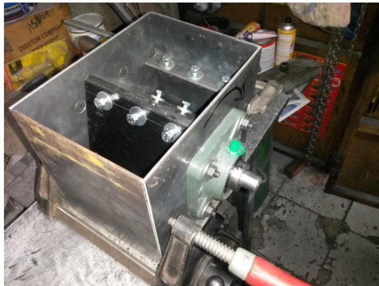
Figura 64. Construcción paredes del triturador
