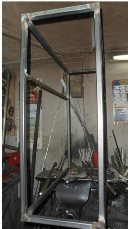
Figura 62. Soldadura de los perfiles
