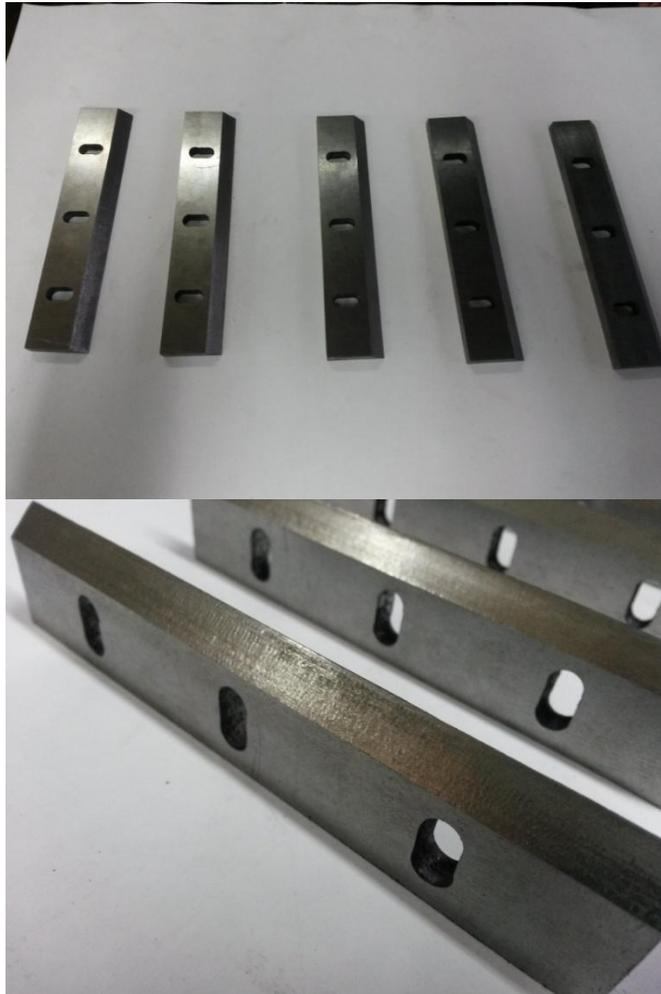
Figura 65. Construcción de las cuchillas.
