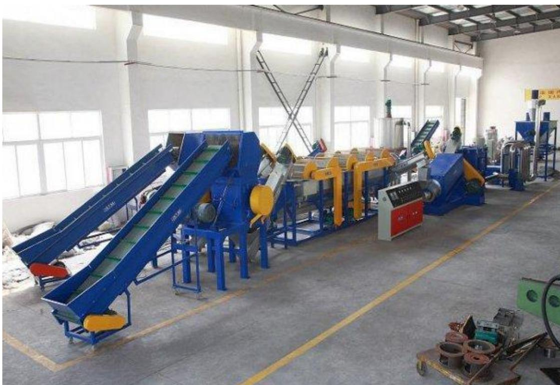
Figura 1. Econo BM-Lavapet-500Kg/hr lavado, secado, molido botellas PET
