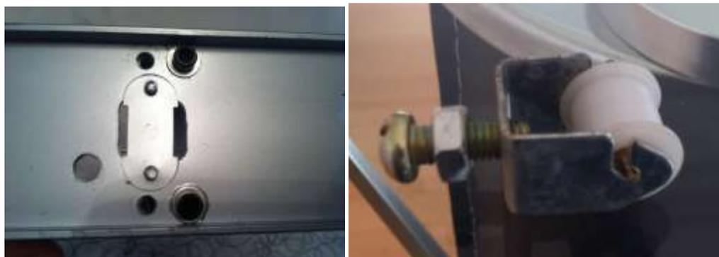
Fig. 33. Tensor de la banda dentada
