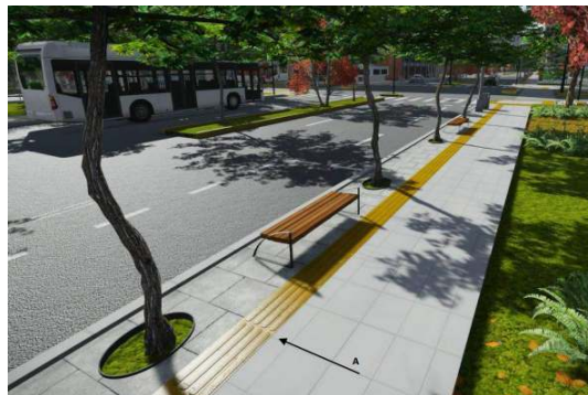
Figura 25 Uso de bandas podotáctiles guía en espacios urbanos
