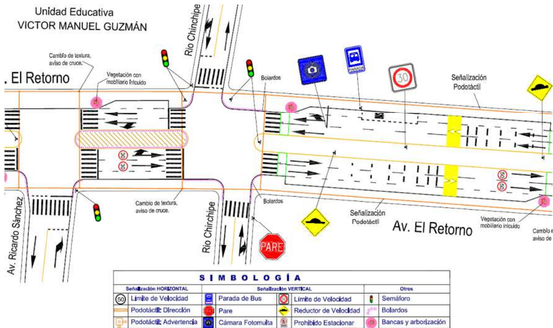
Figura 45 Reformas de infraestructura y señalización: Inicio Tramo 2
