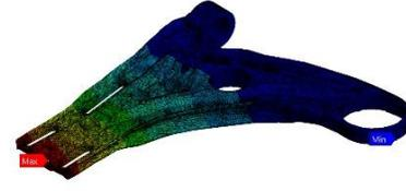
Es interesante observar los cambios realizados después del proceso de optimización topológica. Como se puede apreciar, se realizaron varias perforaciones estratégicas en las zonas donde el factor de seguridad lo permitió, sin embargo, al aplicar las diferentes cargas, la pieza tiende a deformarse por tener un factor de seguridad menor de lo establecido y esta llega a su punto crítico o zona plástica lo que se deforma.
