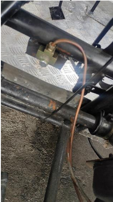
Figura 19 Distribución de Cañerías para la Parte Posterior.
