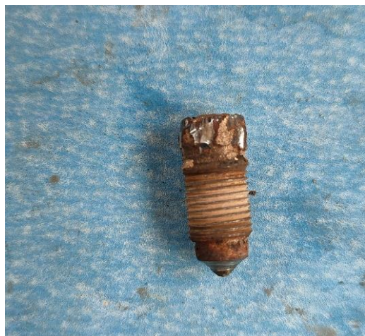
Perno de Purga Mal Estado
