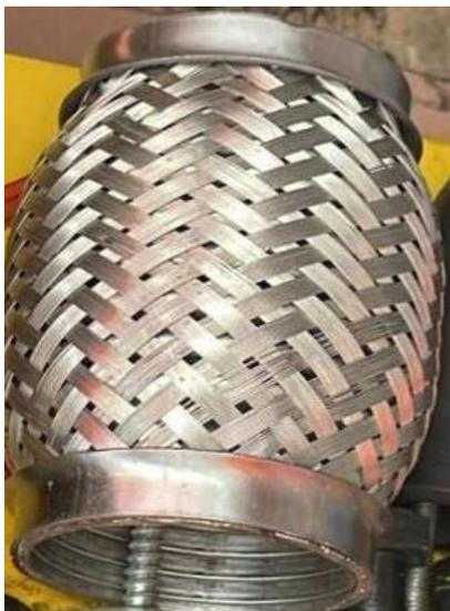
En esta figura 56 podemos observar la verificación del flexible del tubo de escape que se obtuvo para poder evitar un poco las vibraciones del motor, consumo de combustible y las emisiones.
