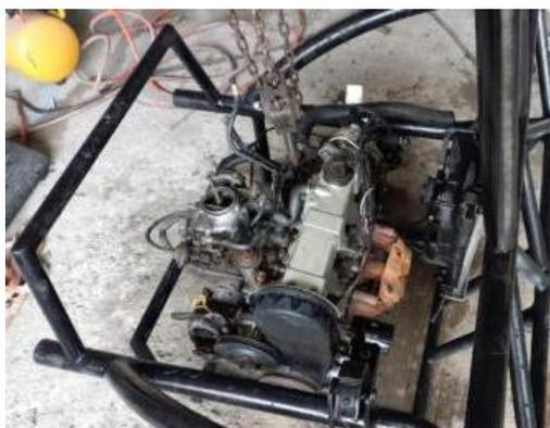
En la figura 54 se puede observar que el motor no cuenta con escape, aquí es donde se procede hacer las tomas de medida para poder adaptar el escape y ver que no vaya a molestar con ningún otro elemento mecánico o eléctrico del motor.
