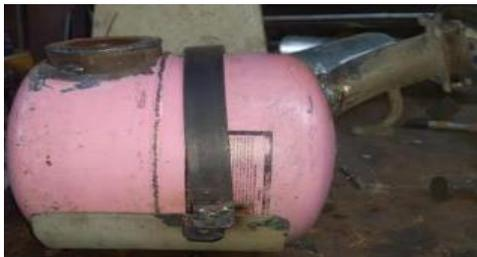
Mientras que en la figura 48 se puede observar cómo fue el proceso de adaptación para la bomba de combustible, la base para que soporte el tanque y su respectivo tubo para que ingrese la gasolina.
