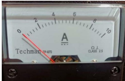
Ilustración 18 Amperímetro analógico de medición carga y descarga.
