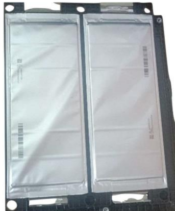
Ilustración 31 celda de bateri HV kia Soul
