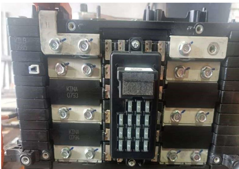
Ilustración 50 Pernos de anclaje entre celdas
