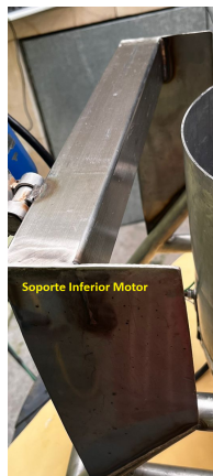
Figura 62. Soporte inferior motor
