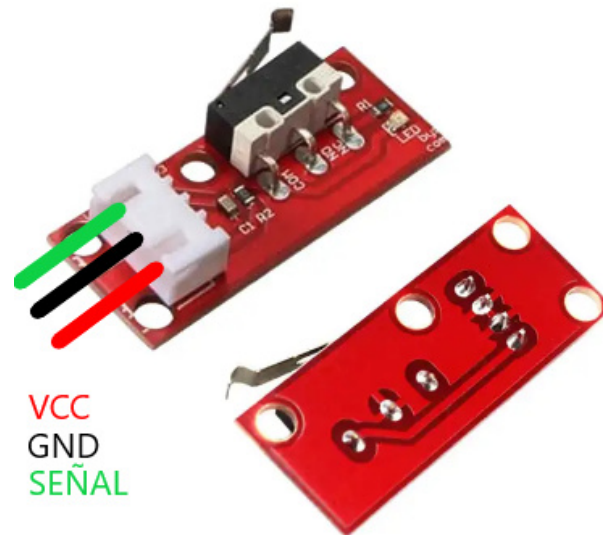
Figura 13. Conexiones fin de carrera.
