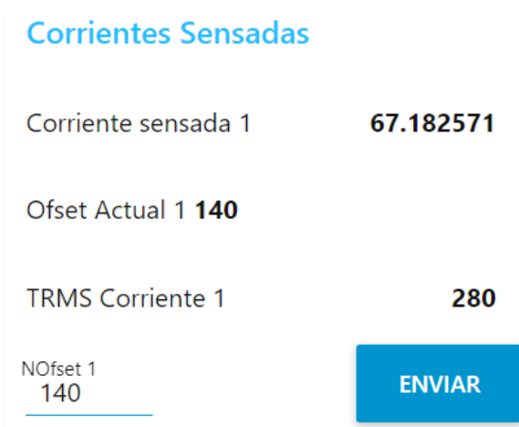
Figura 97. Corrección de sensor con valor de 140.
