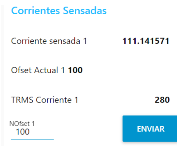
Figura 96. Corrección de sensor con valor de 100.
