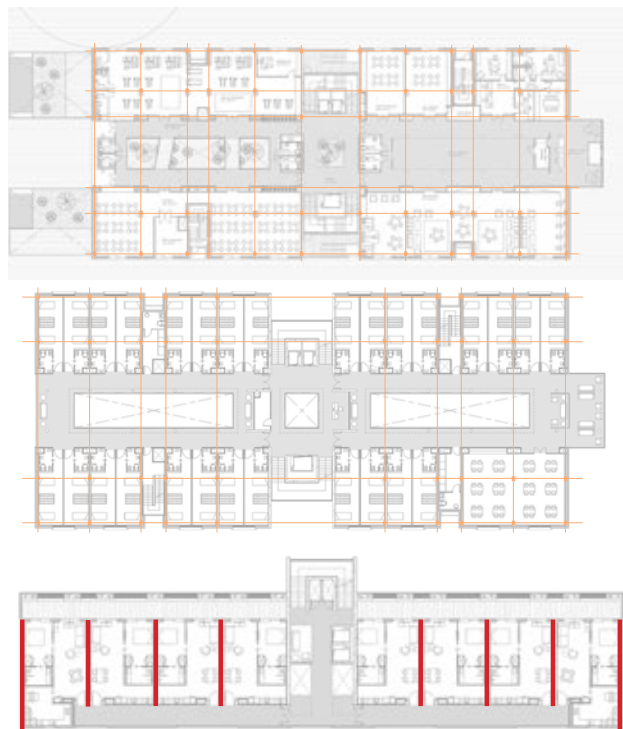
Figura 23. Sistema estructural de cugat nature
