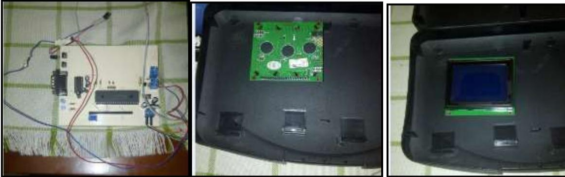
Figura 3.13: Componentes de la placa del opacómetro y pantalla LED
