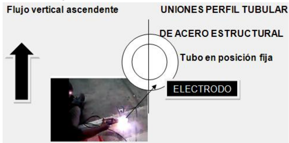
Figura N° 39: Soldadura vertical ascendente
