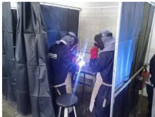
Figura N° 27: Cabina de soldadura
