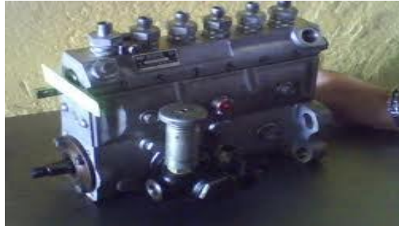
Figura N° 17: Bomba inyección motor
