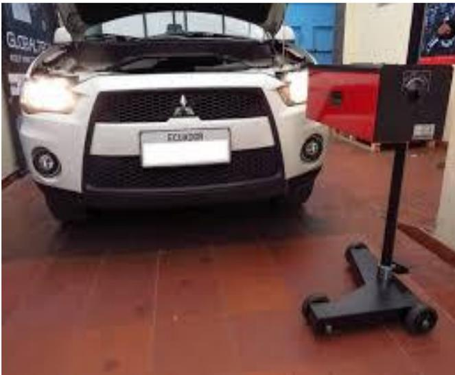
*Nota.* Calibración de faros con el uso del luxómetro automotriz. Tomado de (Guerra Méndez , 2019).
