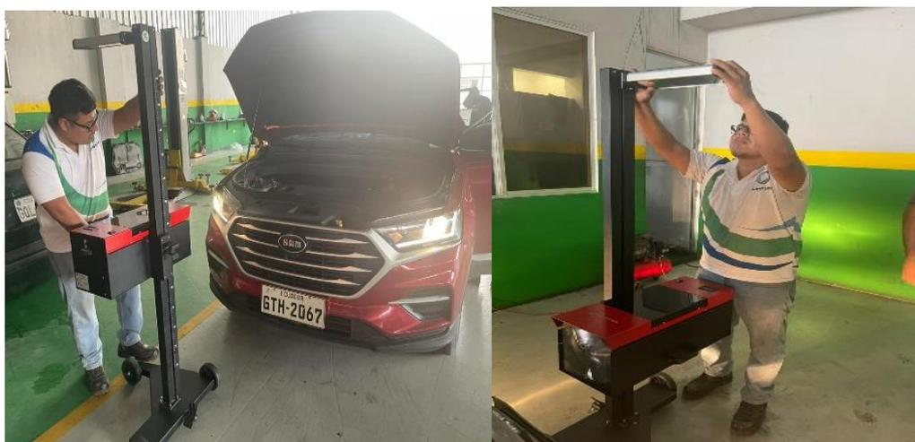
Al realizar la prueba si no se encuentra en el rango se debe realizar un reglaje o la sustitución del foco incandescente. Los valores de trabajo son:
