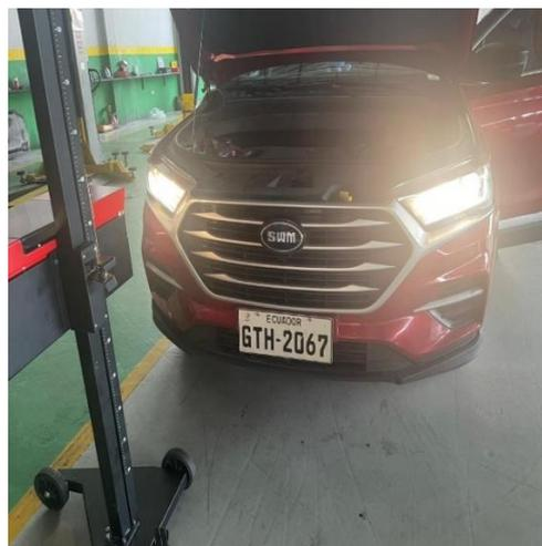
Para la alineación de la visera del espejo buscar dos puntos simétricos en la parte delantera del vehículo (por ejemplo, la parte superior del parabrisas o los faros mismos).
