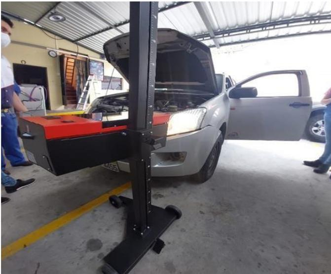
*Nota.* Montaje del luxómetro automotriz para ejecutar las pruebas de calibración de faros. Tomado de (Calderón Matamoros, 2020).
