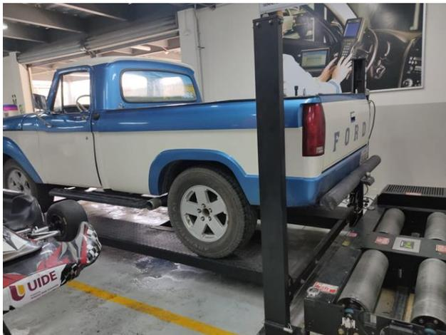
A continuación, se procede a asegurar el vehículo con la ayuda de las correas de seguridad, para esto se observa puntos que no intervengan en mecanismos móviles y con el escape del vehículo, se tomó como punto fijo los postes del elevador para fijar el vehículo, antes de realizar las pruebas observar que estas correas de seguridad se encuentren bien instaladas y templadas para mantener fijo al vehículo.
