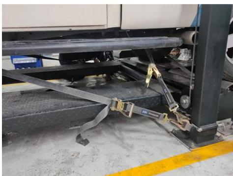
Con el vehículo asegurado correctamente en el dinamómetro, se procede a calibrar la consola donde se obtendrán los resultados de las pruebas que se realizarán en el mismo, en esta parte agregan los datos principales del motor como su cilindrada, número de pistones, el año, marca del vehículo, entre otros datos.
