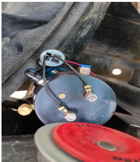
Para tener una alimentación a los sistemas se toma del positivo de la bobina, no es recomendable de la batería debido a que después los sistemas se mantienen encendidos en todo momento y el cable a masa (tierra) en este caso se tomó el de la bobina, pero puede ser de cualquier masa (tierra) que se encuentre en el compartimiento del motor.
