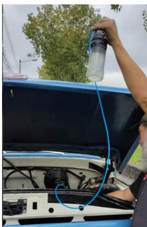
En esta instancia se realizó la instalación de las mangueras donde se transportará el hidrogeno hacia la admisión del motor, al ser un vehículo a carburador se hizo la conexión hacia un vacío del mismo, se necesitó que el motor absorba el H que se genera en cada sistema.
