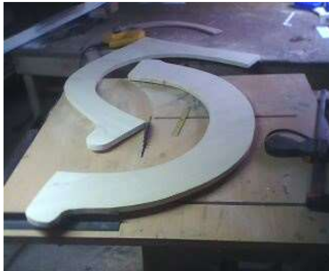
Figura 2.74 Perfiles de la base del molde
