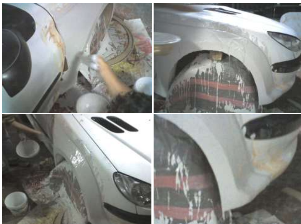
Figura 2.59 Colocado de yeso sobre over fender modelado en arcilla
