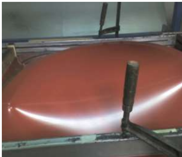
Figura 2.88 Lámina inflada previa a contacto con el molde y succión
