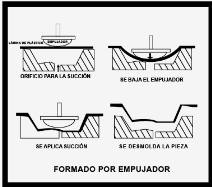
Figura 1.25 Formado con empujador
