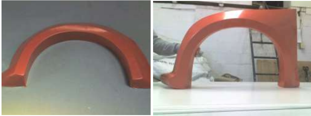
Figura 2.91 Piezas posterior y delantera cortadas
