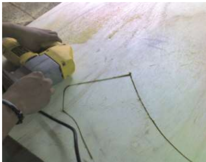
Figura 2.72 Calado del perfil
