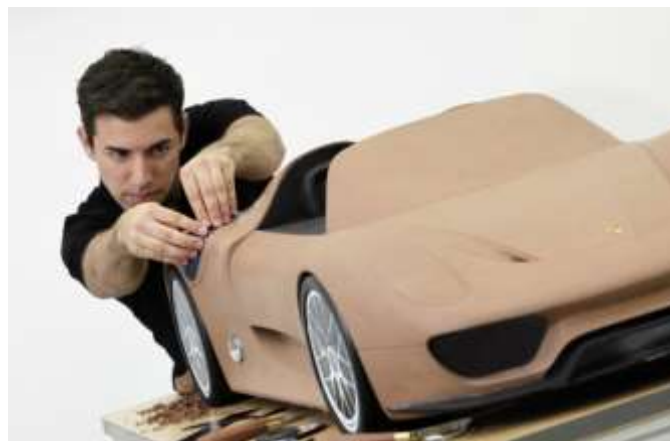
Figura2.46 Modelado de un Porsche en arcilla
