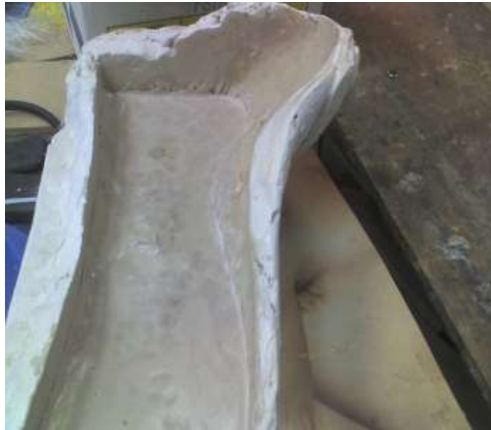
Figura 2.65 Inicio de colado de macilla en molde negativo de yeso
