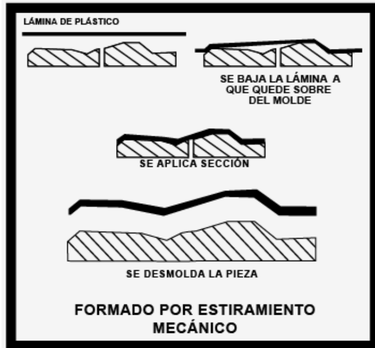
Figura 1.20 Formado por estiramiento mecánico
