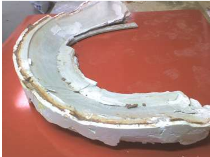
Figura 2.64 Obtención del negativo en yeso del over fender posterior
