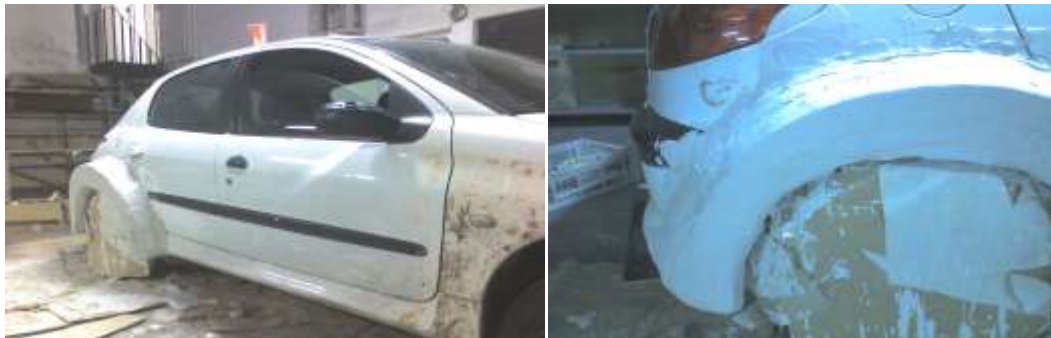
Figura 2.63 Colocado del yeso sobre arcilla
