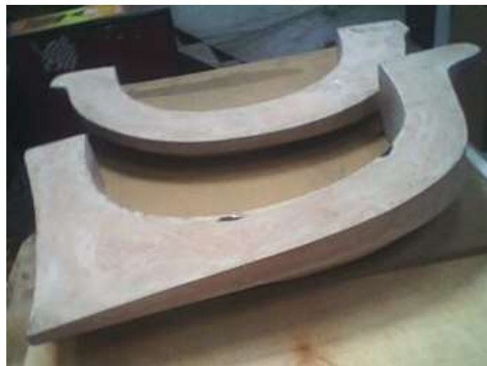
Figura 2.69 Molde de macilla terminado
