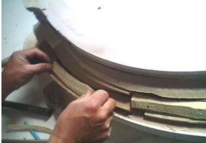
Figura 2.77 Relleno de molde con tiras de madera
