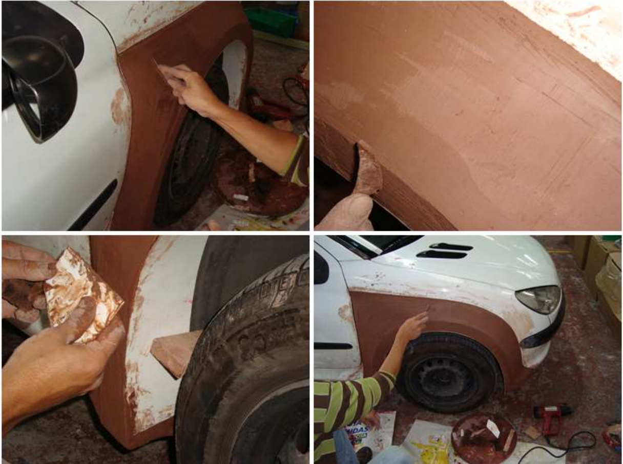
Figura 2.58 Modelado positivo en arcilla del over fender delantero con esteque y espátulas
