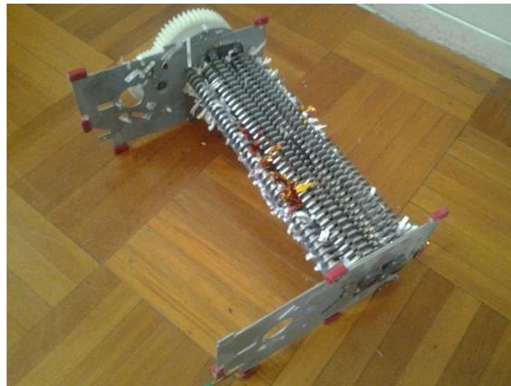
**Figura 3.6: Rodillos de trituración**
