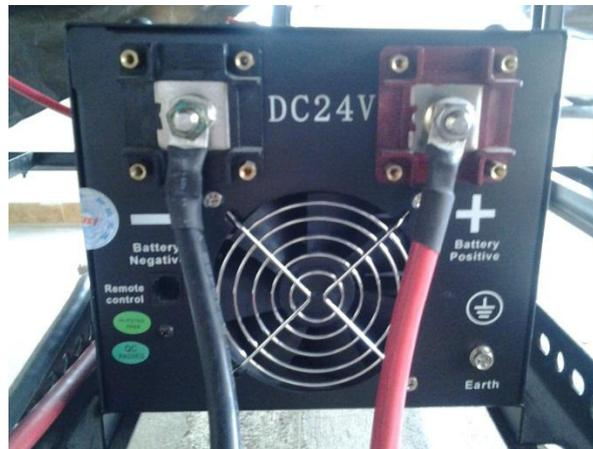
**Figura 3.18: Anclaje de conexiones al inversor**
