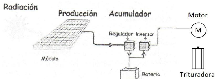
**Figura 3.1: Esquema de funcionamiento de la trituradora ecológica**
