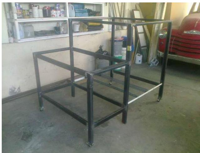
**Figura 3.13: Estructura fija finalizada**
