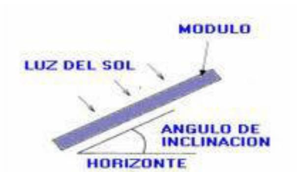
**Figura 3.19: Angulo de inclinación del modulo**
