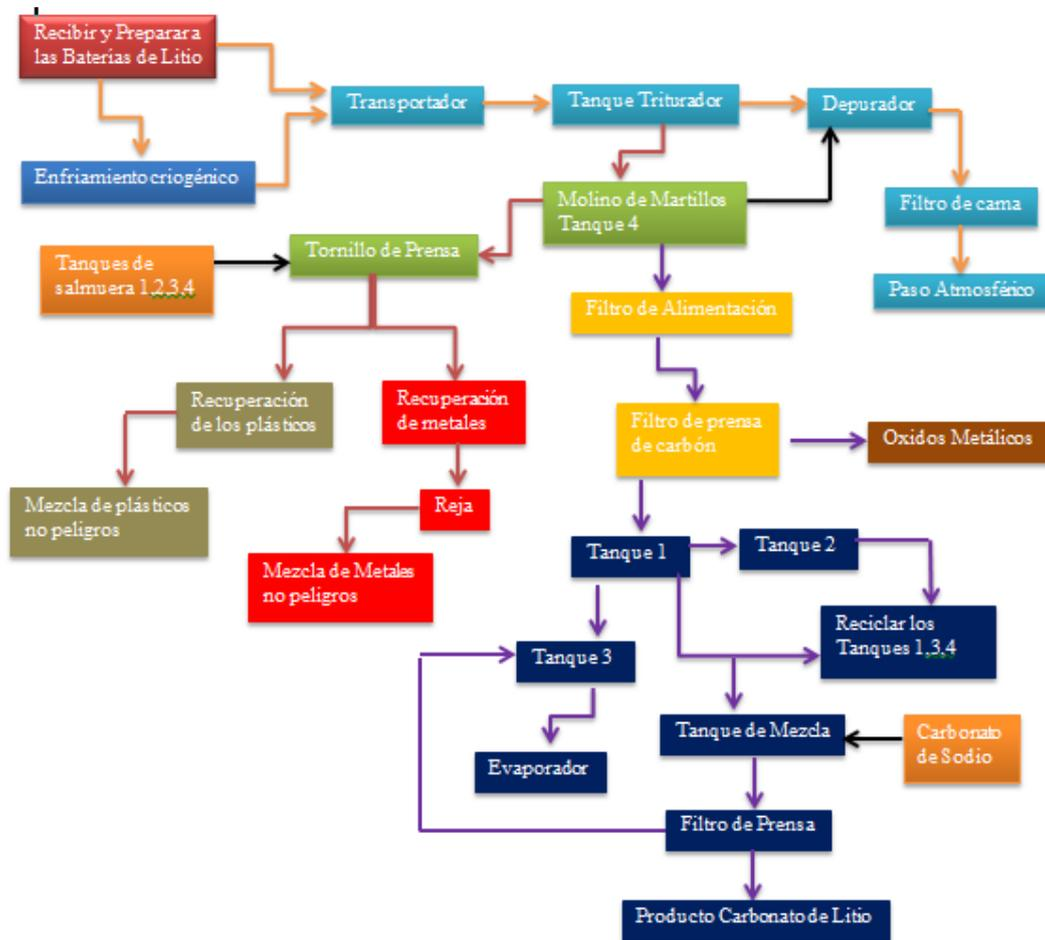
Figura 3.11. Proceso Hidro Metalúrgico de Reciclaje de Baterías de ion – litio por la Empresa Toxco
