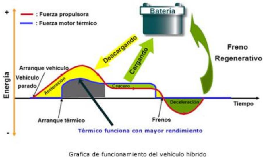
**Figura 2.8. Gráfico del Funcionamiento de Batería del Vehículo Híbrido**
