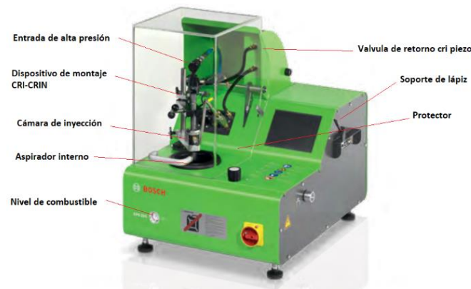
Figura 9. Banco de pruebas Bosch EPS 205
