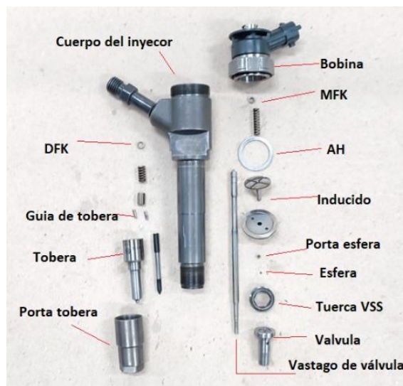
Figura 26. Despiece inyector 0445110250.
