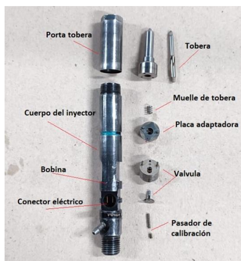
Figura 28. Despiece inyector EJBR03701D.
