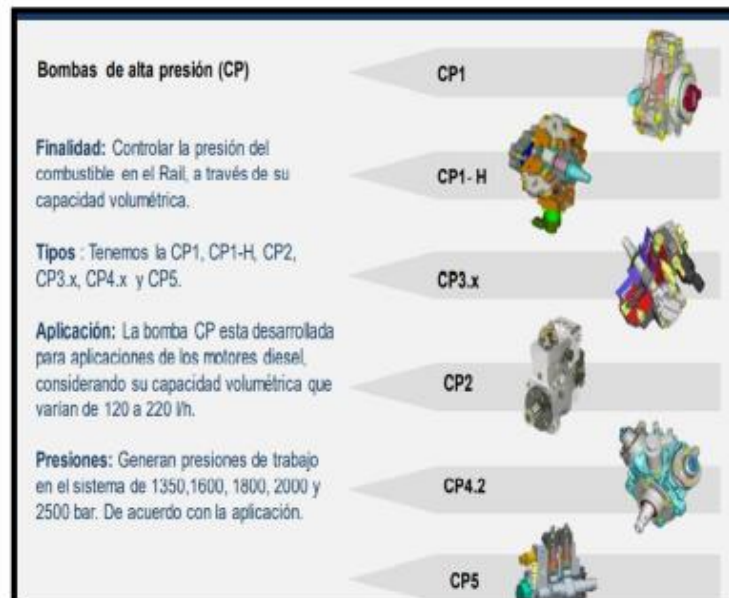
Figura 10. Bombas de alta presión. Fuente : Manual Senati, 2015.
