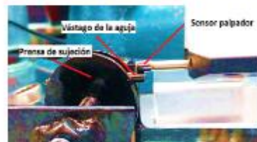
Figura 3. Medición del vástago de la aguja (Bosch)
