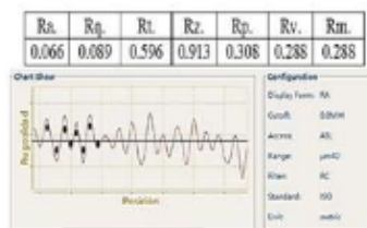
Figura 6 Rugosidad del cono de la aguja nueva de la tobera inyector marca BOSCH.
