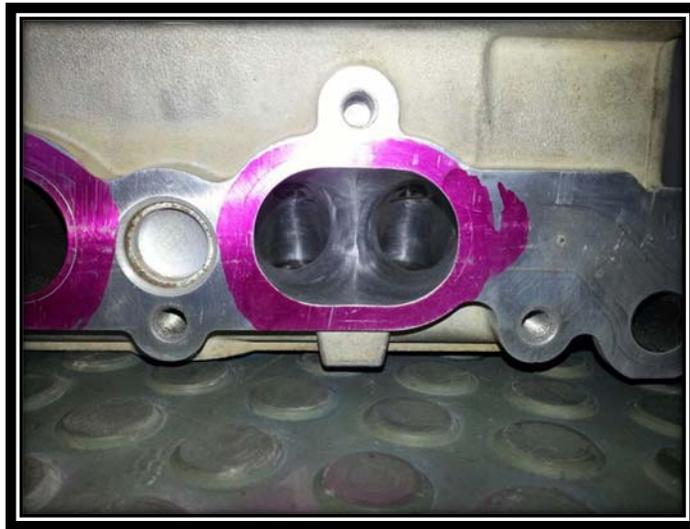
Fig No.2. 22 pulido de conductos de escape
