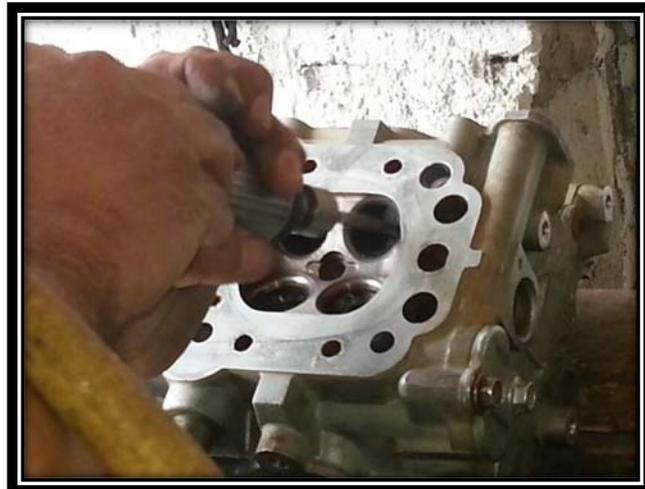
Fig No.2.18 alisamiento interior de conductos
