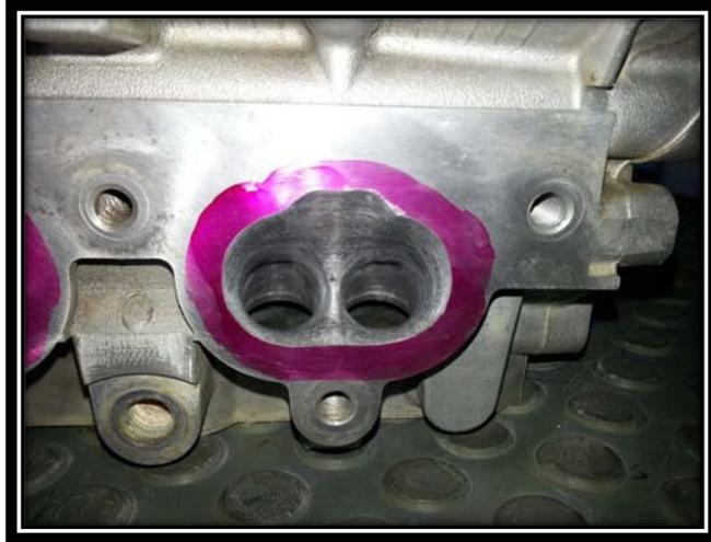
Fig No.2.21 pulido de conductos de admisión
