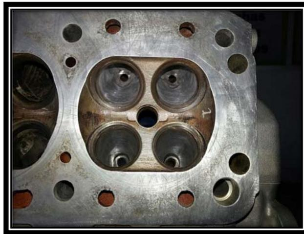
Fig No.2. 20 pulido de conductos
