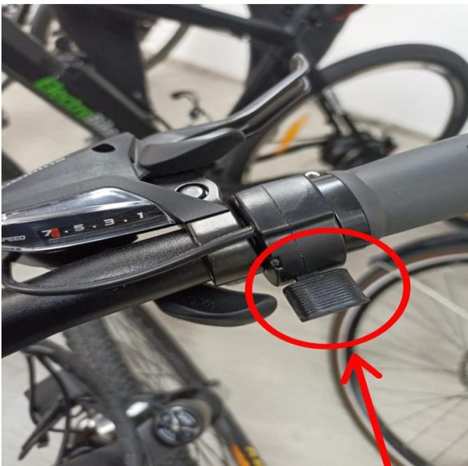
Lo señalado con rojo en la figura 12 es el acelerador de la bicicleta eléctrica. Al
