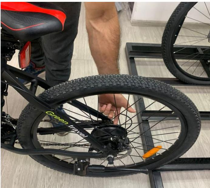
El motor de la bicicleta eléctrica se encuentra en la rueda de atrás, justo donde se señala en la figura 11 y este se encuentra hermetizado, por tal motivo no es visible si no se desmantela para mantenimiento o reparaciones. Esto es importante para el rendimiento de la bicicleta.
