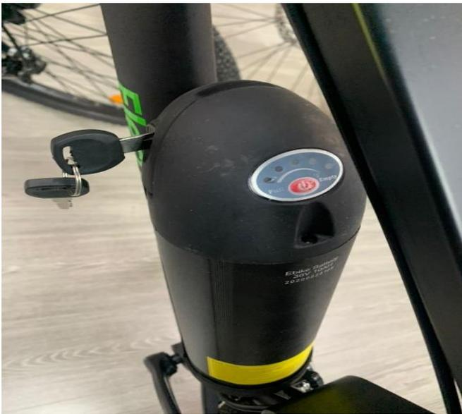
La duracion de las batería se establece en kilometros de recorrido mas no en tiempo. Esta distancia está determinada por las características de fábrica y la capacidad de almacenamiento de energía de la batería. La mayor distancia que estas pueden alcanzar son de 35 km sin pedalear, sólo acelerando dejando que el motor haga su trabajo. Sin embargo, si el usurio realiza el pedaleo siendo esta la ayuda asistida, esta distancia se puede duplicar y en algunos casos llegar a 80km de distancia.
