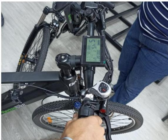
En la pantalla de la bicicleta eléctrica como se puede observa en las figuras 15 y 16, se muestra información importante como la carga de la batería, la velocidad a la que se encuentra en movimiento, los kilómetros recorridos y el nivel de velocidad que se encuentran los cambios.
