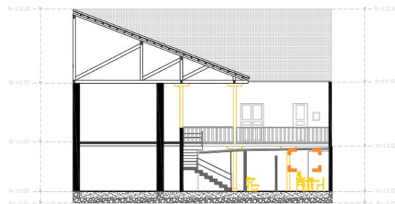
Sección de detalle del corte transversal esquemático
