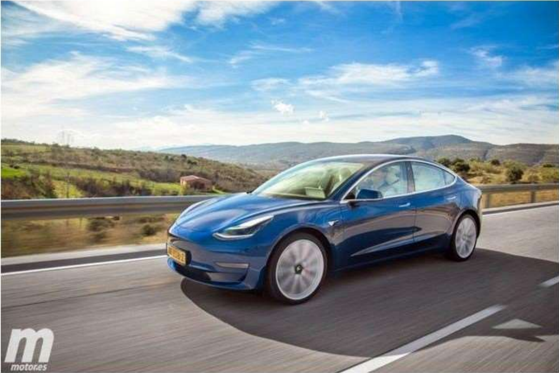
El Tesla Model 3 utiliza un motor delantero de inducción y uno trasero de reluctancia.
