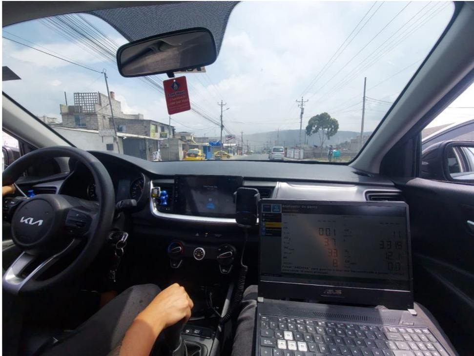
Ilustración 6. Prueba de medición de gases Nox. Foto por (Felipe Pavón, Mateo Mina, Xavier Báez)
