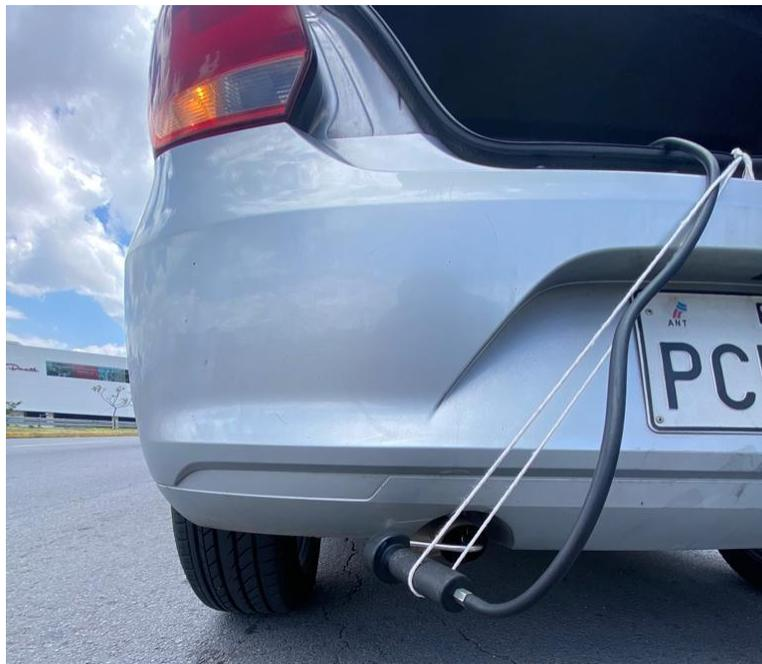
Ilustración 13. Conexión de la sonda Nox al tubo de escape. Foto por (Felipe Pavón, Mateo Mina, Xavier Báez)
