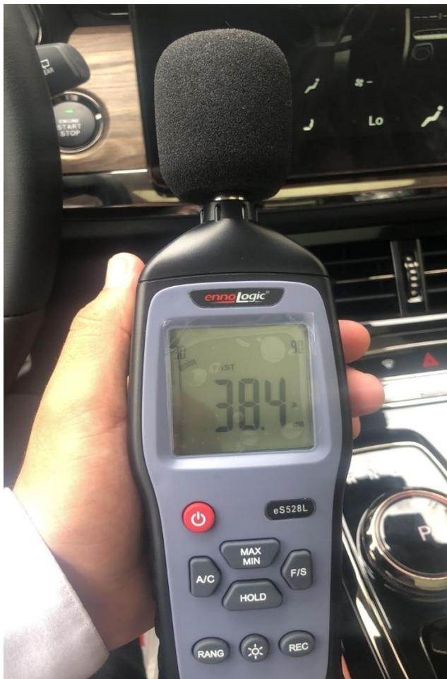
El equipo de medida está formado por un sonómetro tipo 1 con salida de audio que se graba en un soporte digital. El punto de medida se encuentra a unos 7.5 m. de la línea central
