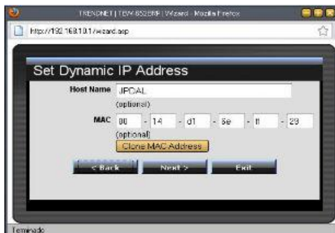
Ilustración 43 Configuración de Host y Dirección MAC.
