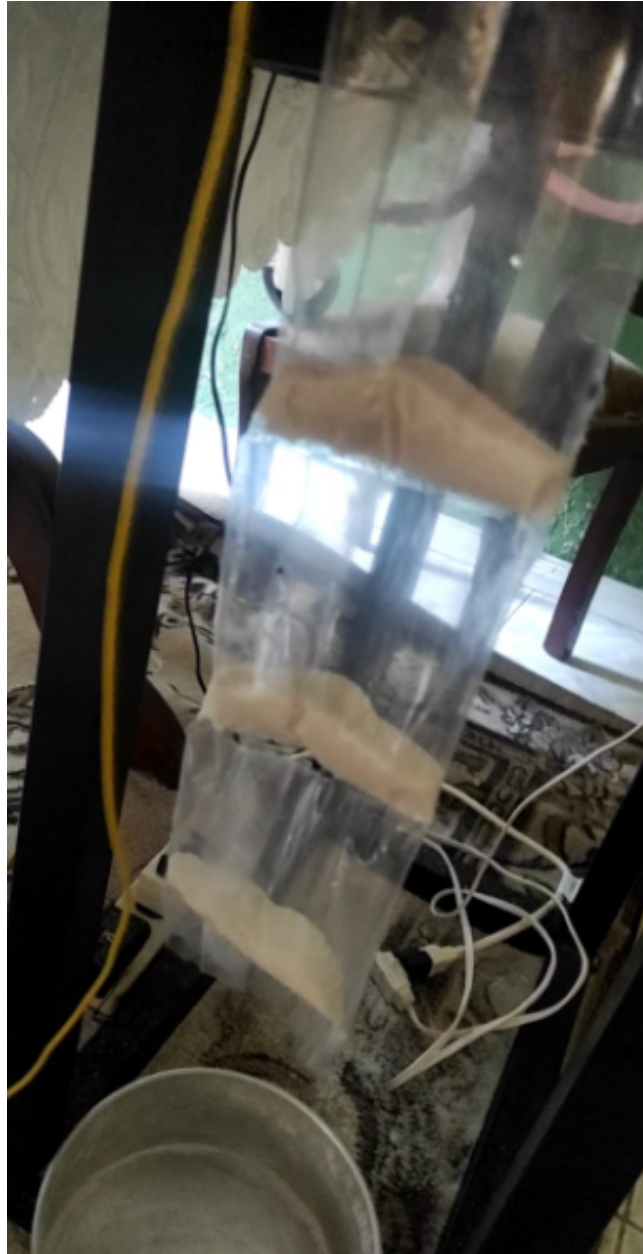
Figura 69: Sellado satisfactorio 3 segundos
