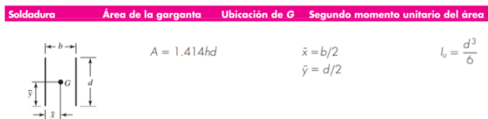
Figura 31: Esquema para el cálculo de soldadura [31]
