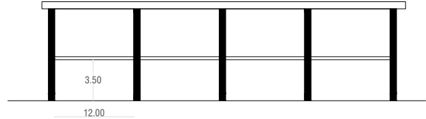
Figura 25. Elevacion de modulo 3.50 x 12m
