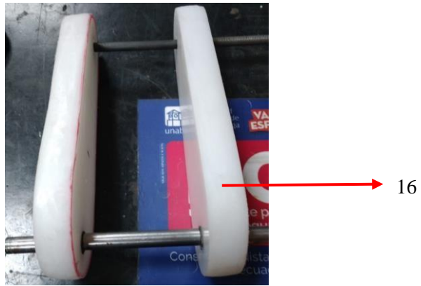
Ilustración 63. Adecuación de una segunda biela para el mecanismo del banco.
