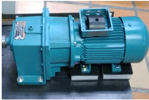
Ilustración 34. Motor y caja reductora empleados en el banco de pruebas.
