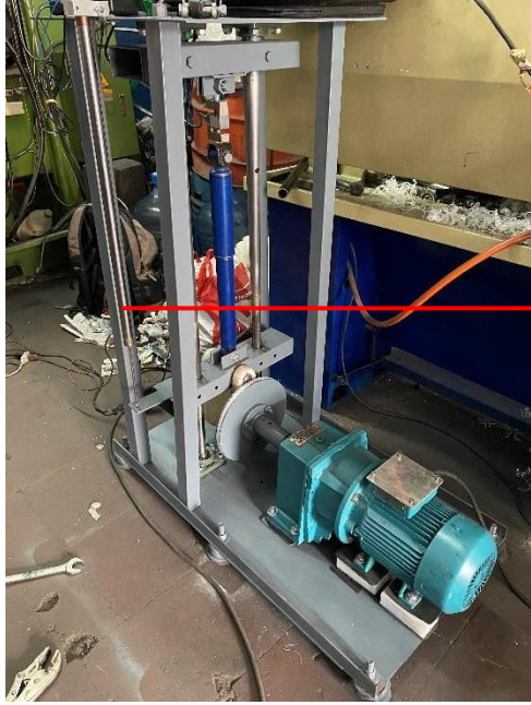
Ilustración 67. Sensor LVDT en el banco de pruebas.
