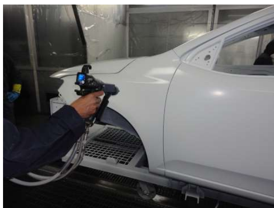
Figura 5. Proceso de aplicación de pintura fondo.
