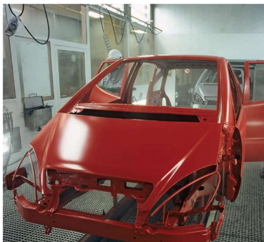
Figura 6. Proceso de aplicación de pintura esmalte y barniz.
