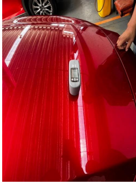
Imagen 8: Medidor de brillo sobre el área a realizar la prueba
