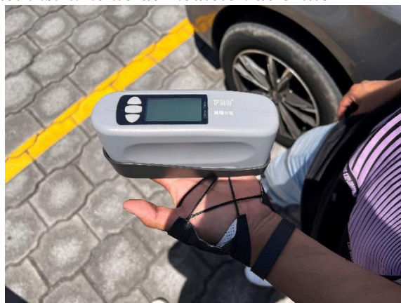
Imagen 5: Encendido del instrumento de medición de brillo
