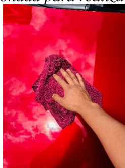
Imagen 4: Limpieza de área seleccionada para realizar medición de brillo
