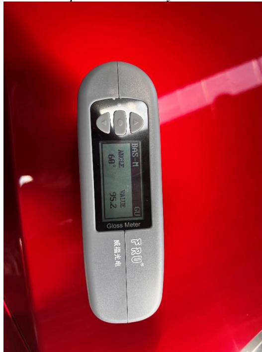
Imagen 9: Medición de brillo en capó de vehículo y obtención de datos
