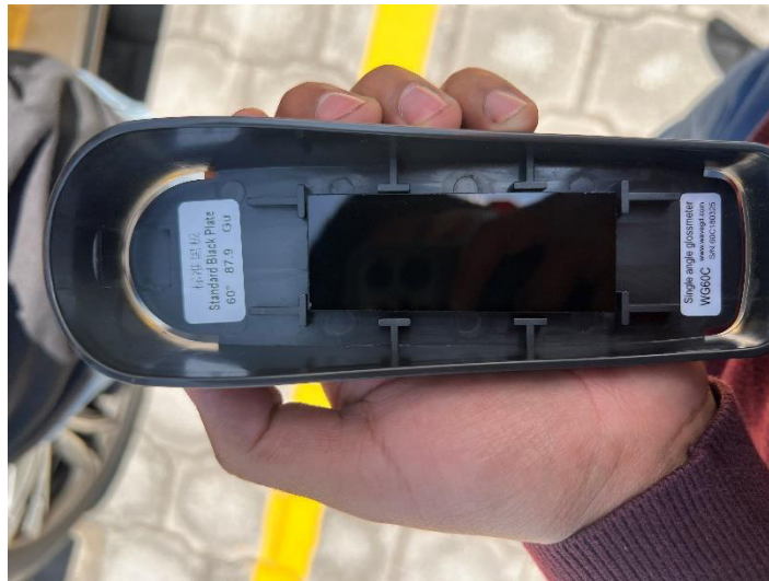
Imagen 7: Tapa de medidor de brillo con calibrador
