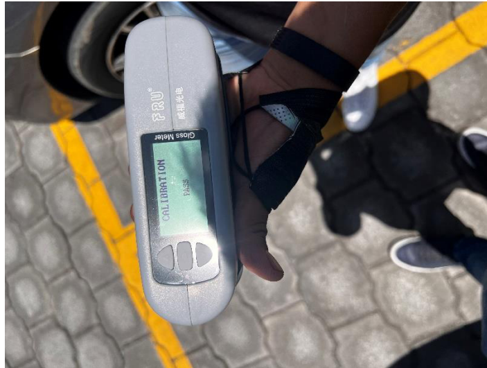
Imagen 6: Calibración automática del instrumento de medición de brillo
