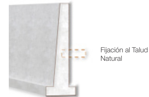
Figura 45. Muros Hijados al Suelo y Talud Natural Fuente: Elaboración Propia
