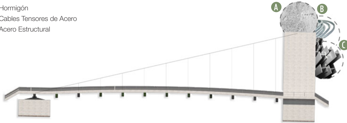
Figura 48. Materialidad Puente de Reconexión Fuente: Elaboración Propia
