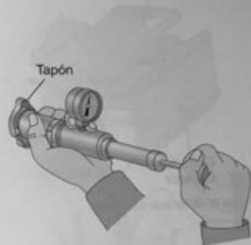
Figura 15.39. Comprobación de las válvulas de presurización.
