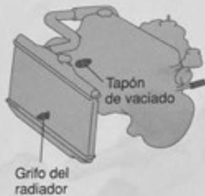
Figura 15.43. Vaciado del circuito.
