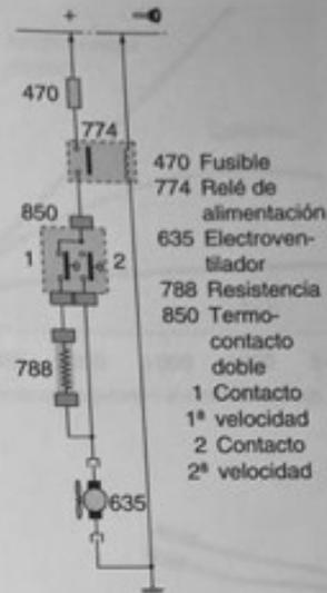
Figura 15.27. Circuito con termocontacto y dos velocidades de ventilador.
