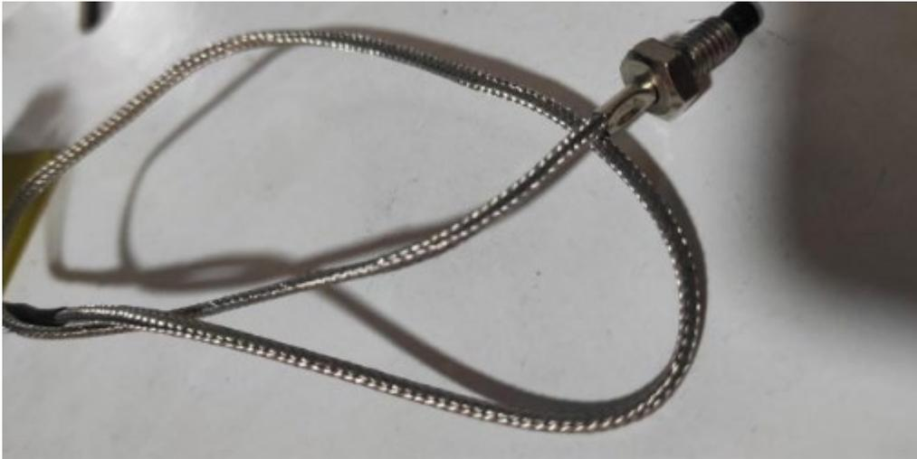
*Figura 10. Termocupla Utilizada en circuito original Fuente: Autores*
