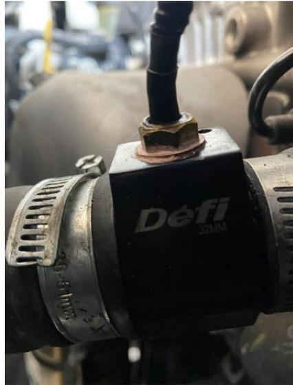
Figura 4. Adaptación para sensor Fuente: Autores
