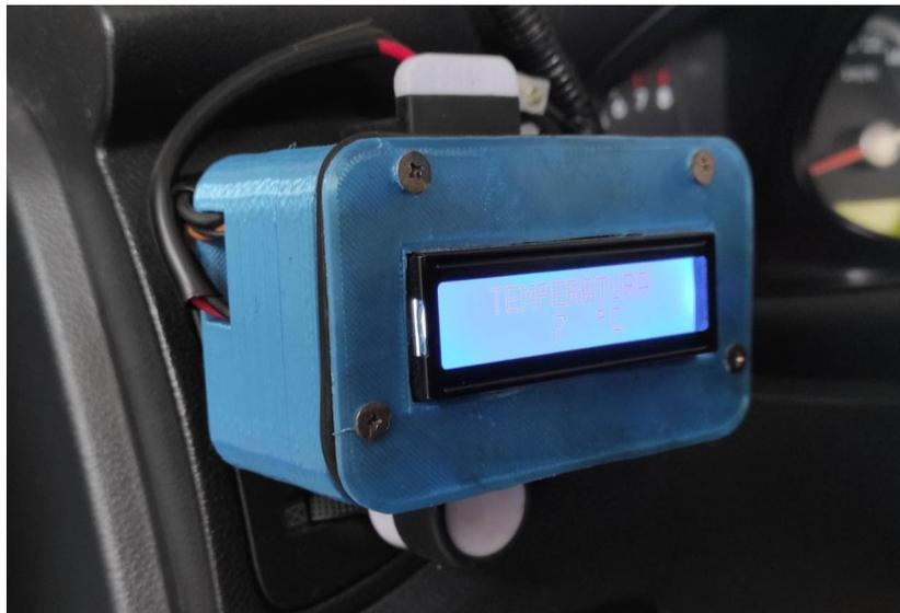
Figura 9. Caja LCD de información de temperatura al usuario Fuente: Autor
