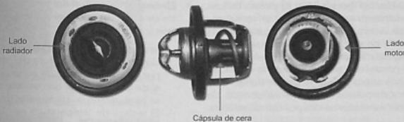
Figura 1.69. Termostato de cápsula de cera.
