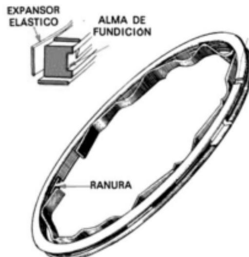
FIG. 4-14. Segmento de cuatro piezas de sección central hecha de hierro fundido.
