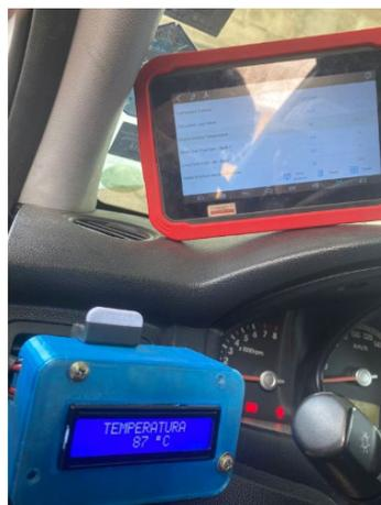
Figura 3. Medición de temperatura del motor mediante dispositivo Fuente: Autores
