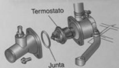
Figura 15.40. Desmontaje del termostato.
