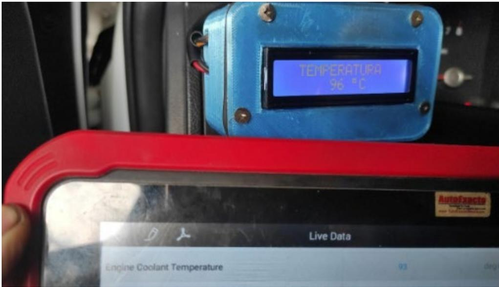
*Figura 16. Diferencia de temperaturas con el scanner automotriz Fuente: autores*
