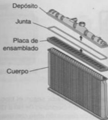
Figura 15.12. Ensamblado del depósito del radiador.
