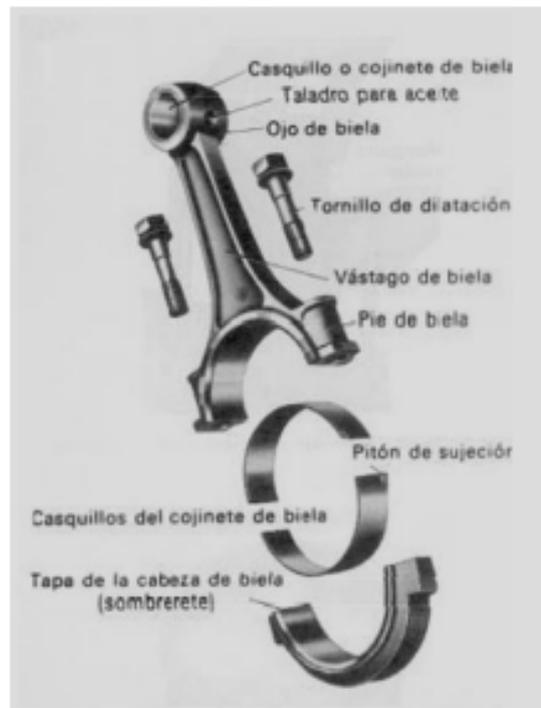
*Figura. 7. Partes de la biela*
