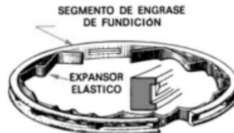
Por regla general, los segmentos con expansor se emplean para regular el aceite en aquellos cilindros cuyas paredes estén excesivamente conificadas u ovalizadas. Además, como los expansores tienden a mantener al pistón centrado dentro del cilindro ayudan también a reducir o a eliminar el golpeteo.
