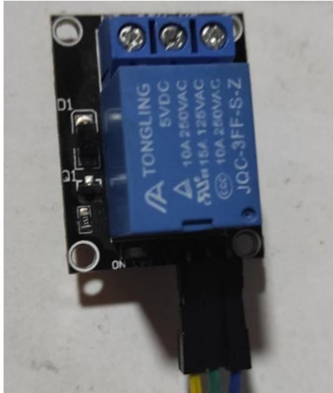
Figura 12. Modulo Rele Fuente: Autores.
