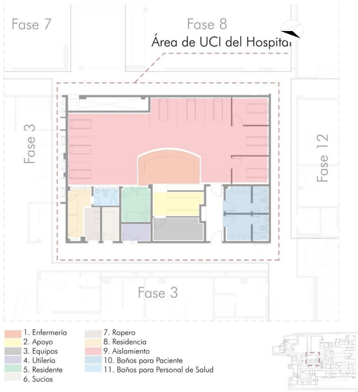
Figura 65. Planta actual del área de UCI
